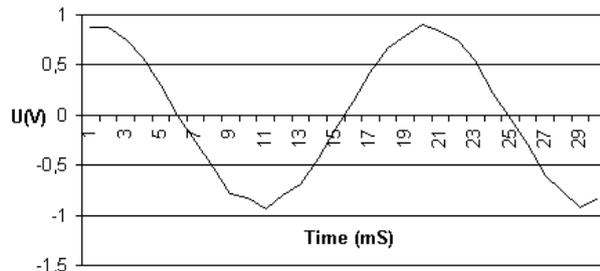
Регистрация сигнала частотой 50 Гц в одноканальном режиме. Время измерения 1 мсек/отсчет. Правая картинка отображает начальную часть левой (растянуто по времени).
