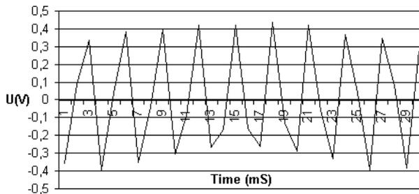
Регистрация сигнала частотой 300 Гц в одноканальном режиме. Время измерения 1 мсек/отсчет. Правая картинка отображает начальную часть левой (растянуто по времени).
