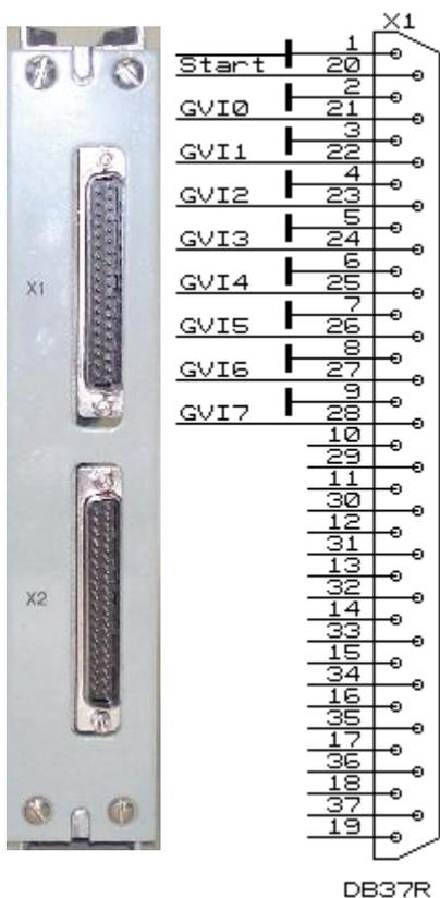
На разъем X1 выведены выходы задержанных импульсов и вход импульса запуска. Выходы задержанных импульсов имеют общую «землю», соединенную с «землей» всего устройства. Стартовый вход имеет свою персональную «землю», которая с «землей» устройства не соединена, т.е. этот вход гальванически изолирован от устройства.
