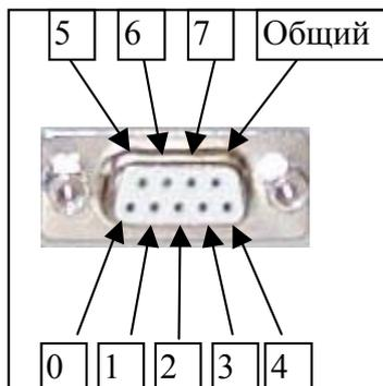
Разъем **Control** предназначен для контроля выходных импульсов (например, осциллографом), а также может быть использован для подключения к устройству приемников задержанных импульсов. Используется разъем типа DB9F.
