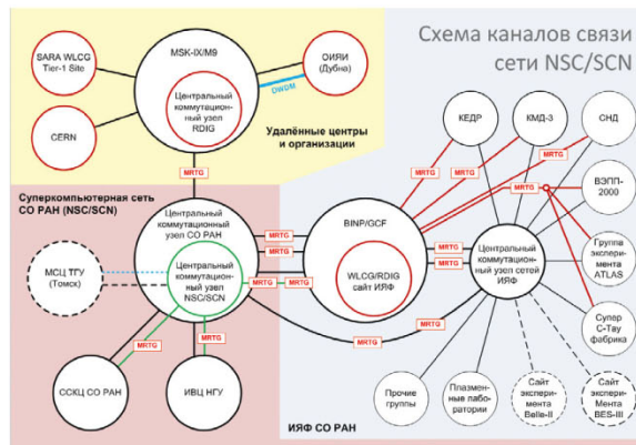
► Рис. 1. Структура суперкомпьютерной сети ННЦ. Зелеными линиями показаны основные 10 GbE соединения, а пунктиром — планируемые группы и связи с ними. Отмечены точки сбора статистики.
