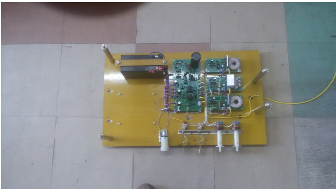
Рис. 2 Фотография смонтированного и отлаженного модуля регистрации тока и потенциала зонда
