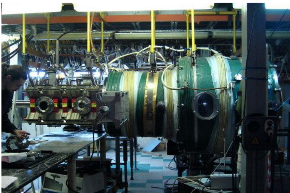
Рисунок 5 - Соленоид и вакуумная камера станции
