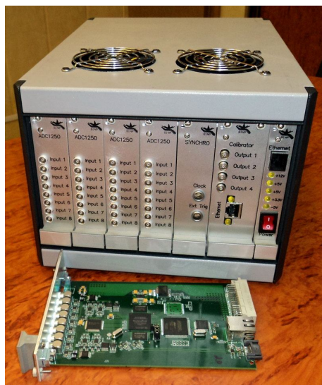
Рисунок 6 - 4-х модульный кейт и плата одного модуля ADC1250.
