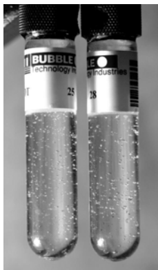
Рис. 3. BDT детекторы после генерации нейтронов.
