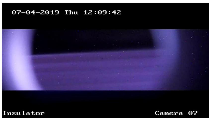
Рисунок 7. Свечение на гофрированном изоляторе при пробое по изолятору
