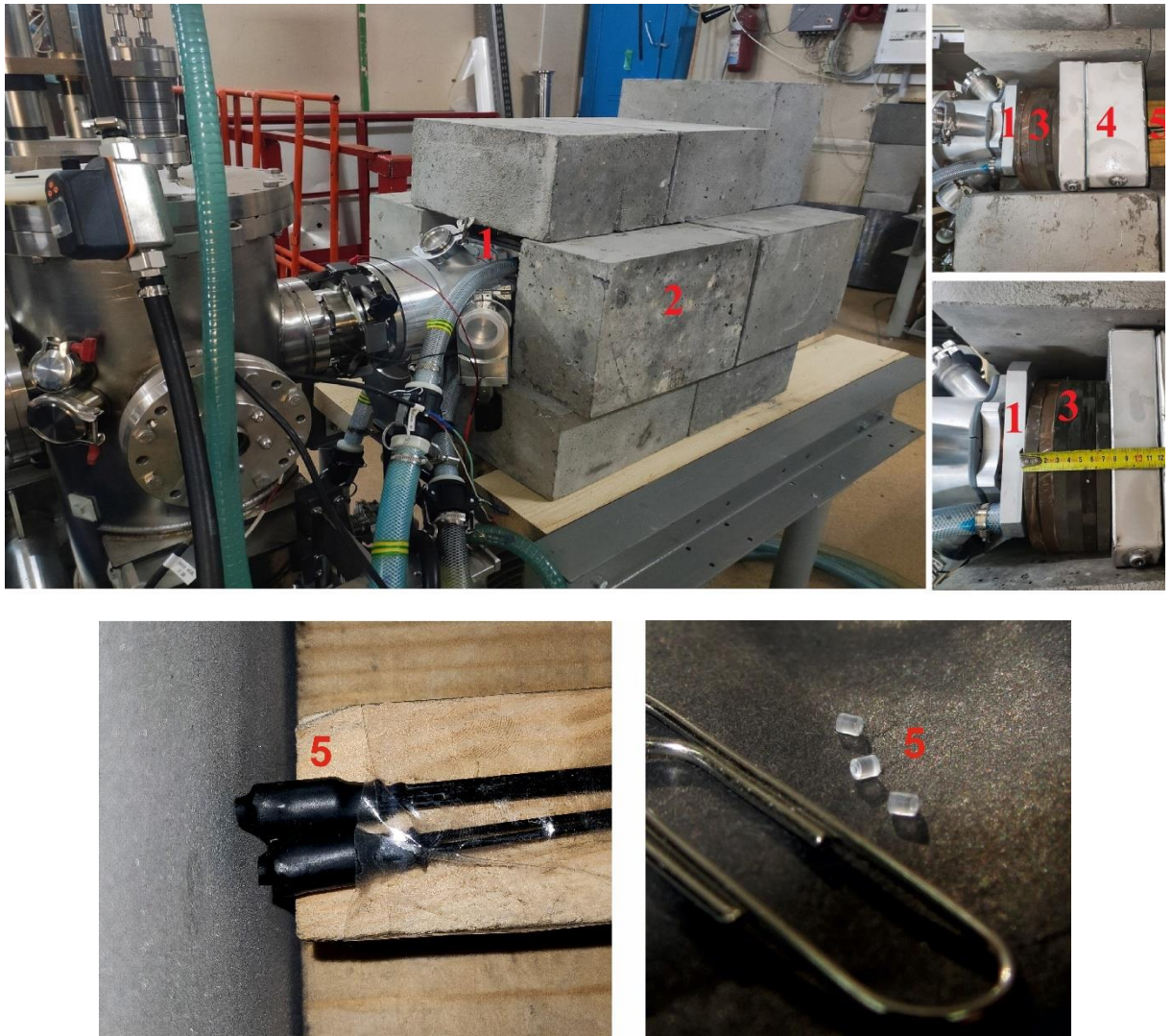
Рисунок 11 - Фотографии прототипа системы замедления нейтронов: 1 – литиевая мишень, 2 – бетонные блоки, 3 – пластины оргстекла, 4 – замедлитель из воды/тяжелой воды, 5 – детектор нейтронов
