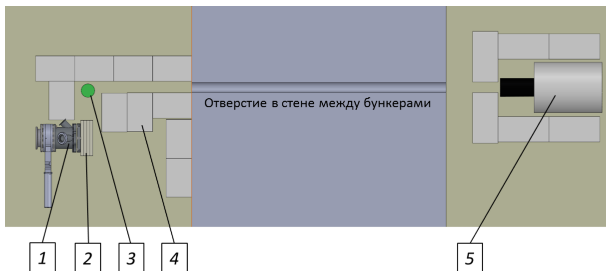
Рис. 9. Схема эксперимента: 1 – литиевая нейтроногенерирующая мишень, 2 – оргстеклянный замедлитель, 3 – образец с бором, 4 – свинцовая и бетонная защита, 5 – гамма-спектрометр
