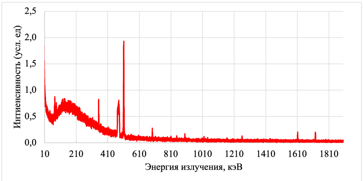
Рисунок 16. Спектр от образца борной кислоты с содержанием бора 160 ppm.
