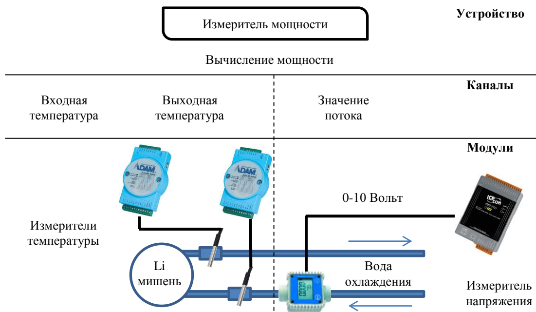
Рисунок 27 – Эквивалентная схема измерителя мощности
