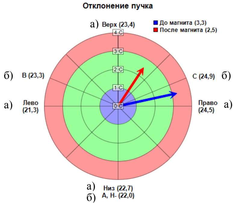
Рисунок 39 – Панель отклонения пучка: а) значение с охлаждаемой диафрагмы; б) значения после поворотного магнита
