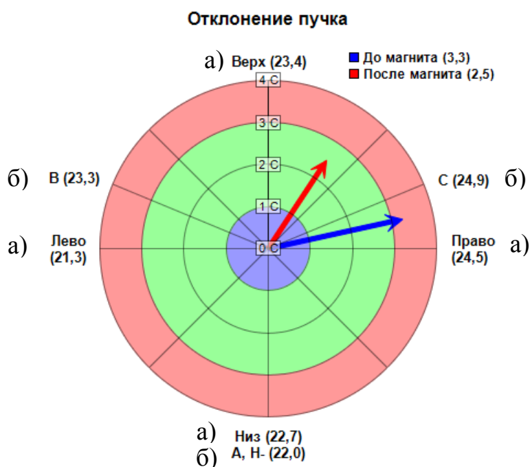
Рисунок 6 – Панель отклонения пучка: а) значение с охлаждаемой диафрагмы; б) значения после поворотного магнита
