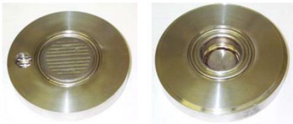
Рис. 2. Мишень с жидкометаллическим охлаждением.
