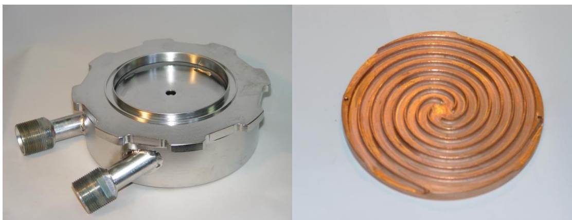
Рис.9. Фотографии собранной мишени без приемника пучка (слева) и медного диска со стороны охлаждаемой водой.
