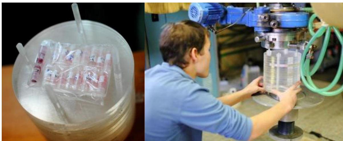
Рис. 37. Укладка клеточных культур в фантом (слева) и выставление фантома под литиевую мишень.
