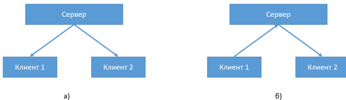
Рисунок 43. Распространение данных. Инициирование обновления переменной происходит: а) сервером; б) клиентом.
