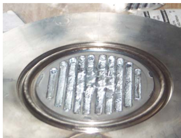
Рис. 83. Приёмник пучка без молибденовой фольги после испытаний.
