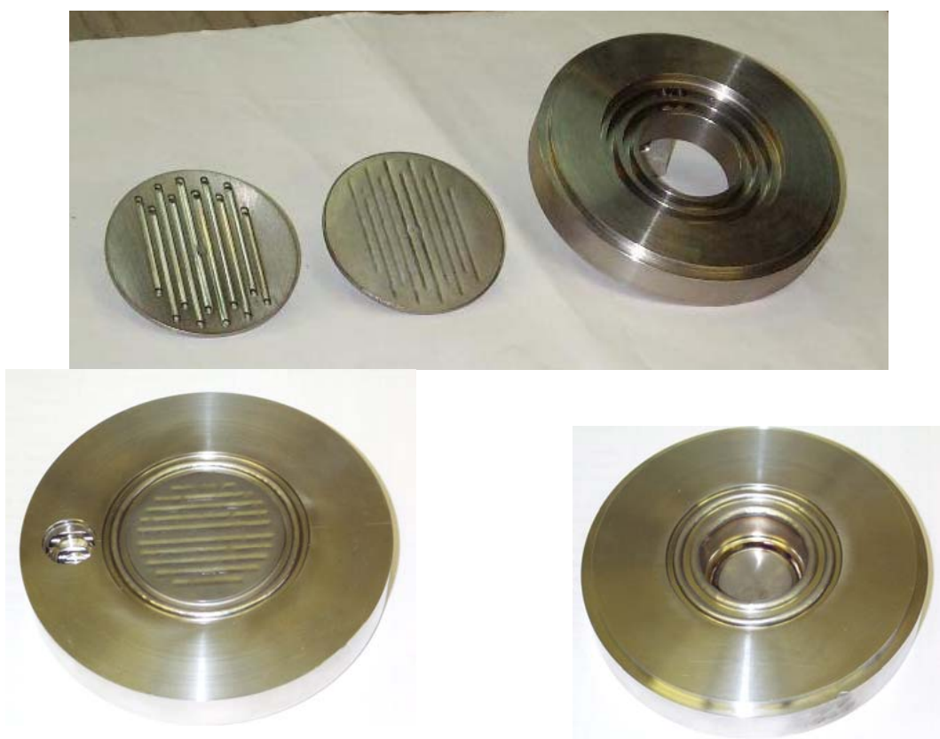
Рис. 69. Мишень перед сборкой (вверху) и после (слева – вид со стороны протонного пучка, справа – с противоположной стороны).
