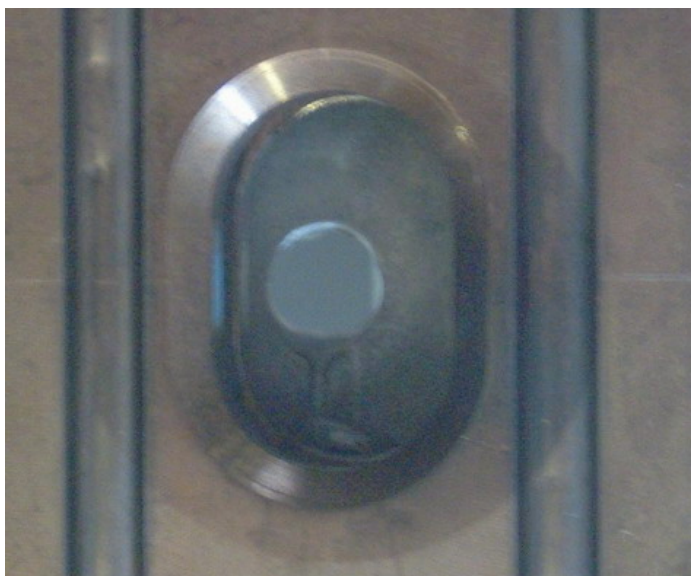
Рис. 42. Расплавленный след протонного пучка на мишени из нержавеющей стали.
