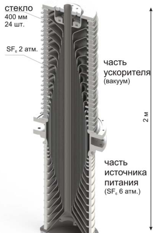
Рис. 15. Проходной изолятор.
