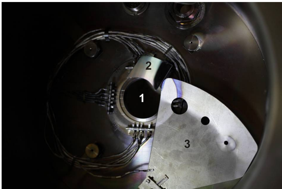
Рис. 24. Фотография подвижной диафрагмы 3 на входе в ускоритель (вид со стороны обдирочной мишени). Показаны также: 1 – входной канал инъекции пучка диаметром 50 мм, 2 – металлическое зеркало.
