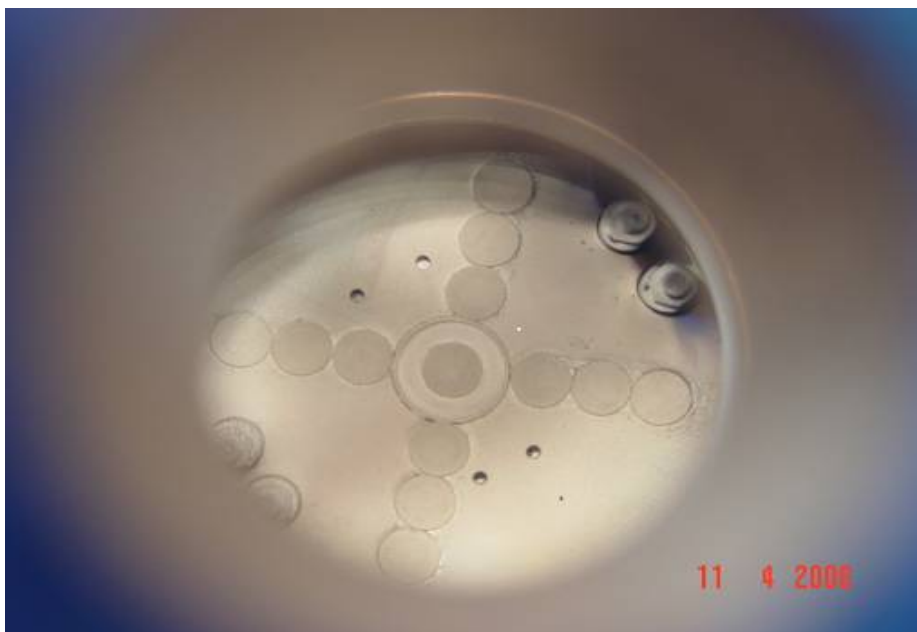
Рис. 101. Фотография мишени со свидетелями, сделанная через окно в вакуумной камере сразу после напыления лития.
