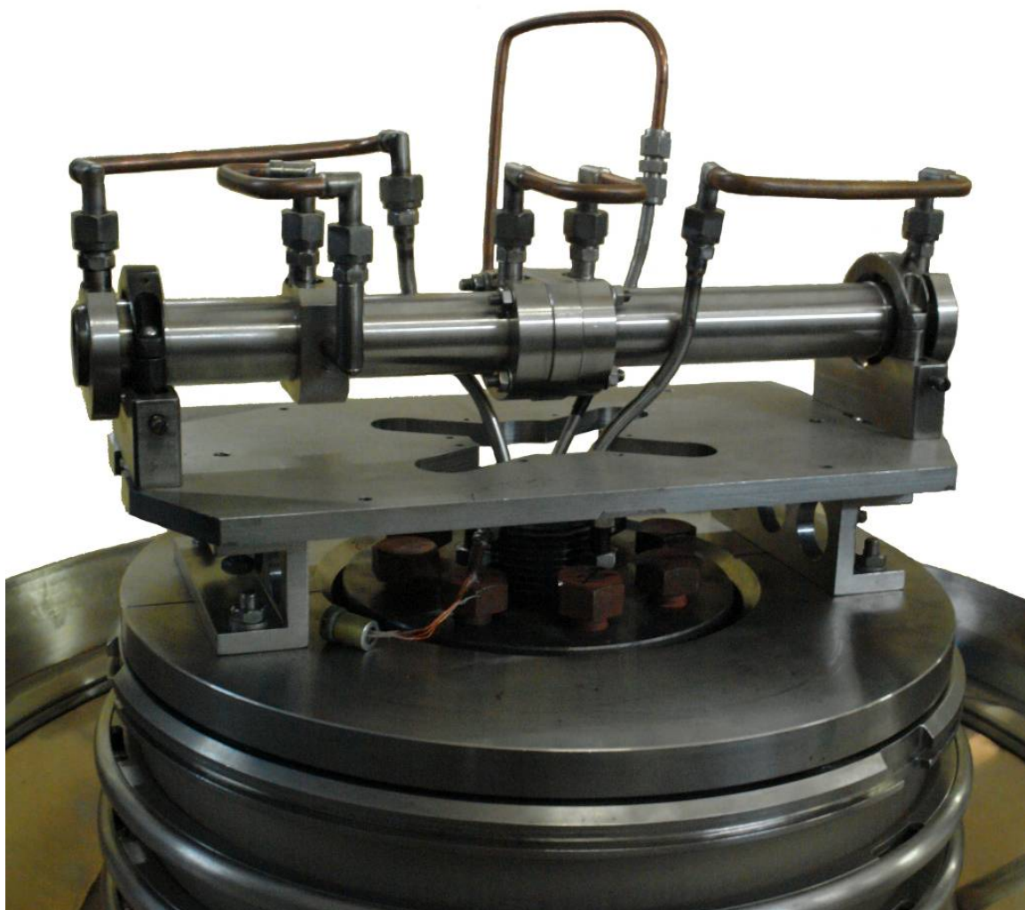
Рис. 27. Фотография 16-мм обдирочной мишени, установленной на проходной изолятор.
