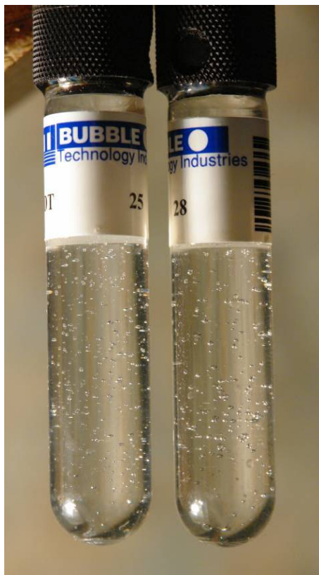
Рис. 140. Пузырьковые детекторы BDT после генерации нейтронов.
