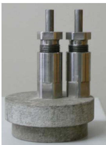
Рис. 91. Токоввод с изолятором (слева) и мишень с нагревателем и токовводом в сборе (справа).
