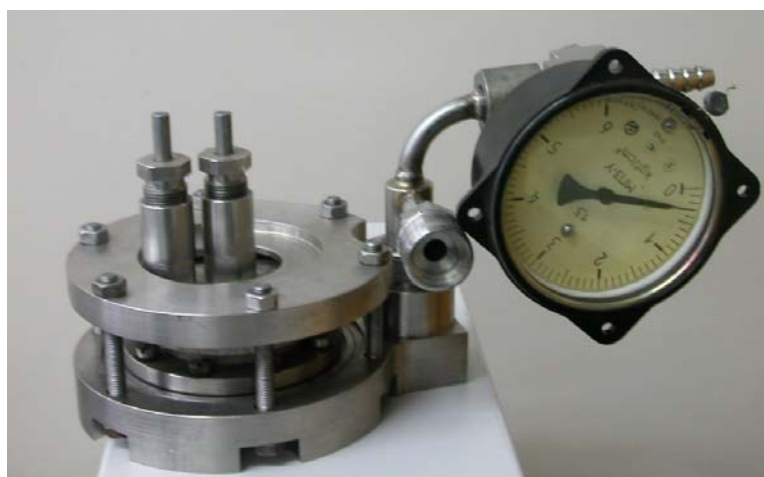
Рис. 91. Токоввод с изолятором (слева) и мишень с нагревателем и токовводом в сборе (справа).
