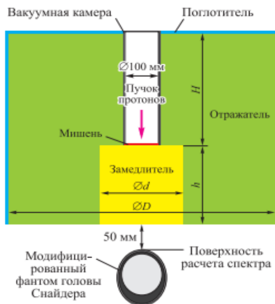
Рисунок 10 . Геометрия системы формирования пучка и расположение модифицированного фантома головы Снейдера [2]
