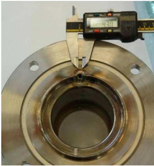
Рис. 55. Поврежденная вакуумная камера, установленная после поворотного магнита (слева) и массивная медная вставка для предотвращения повреждения (справа).
