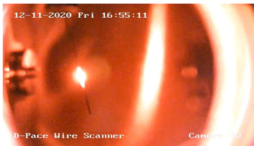
Рис. 73. Фотография проволочки сканера, пересекающего струю протонов при токе пучка протонов 3 мА
