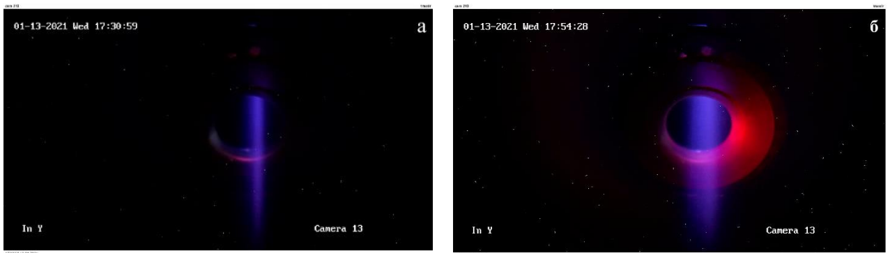
Рис. 79. Изображение входной диафрагмы внешнего ускоряющего электрода в оптимальном (а) и сильном (б) режимах фокусировки. Синий цвет — ускоряемый пучок отрицательных ионов водорода
