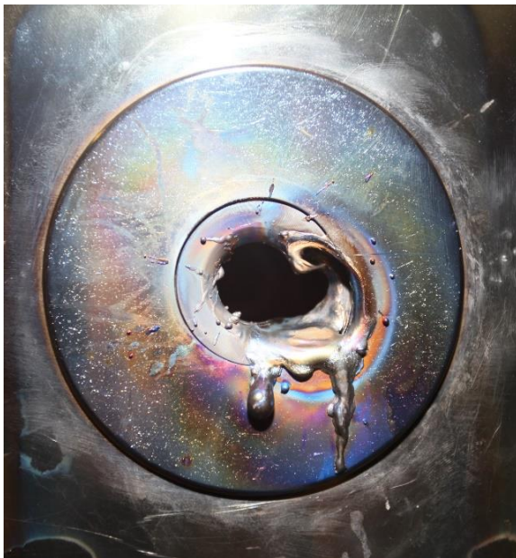
Рис. 33. Фотографии диафрагм ускоряющих электродов после их повреждений пучком ионов
