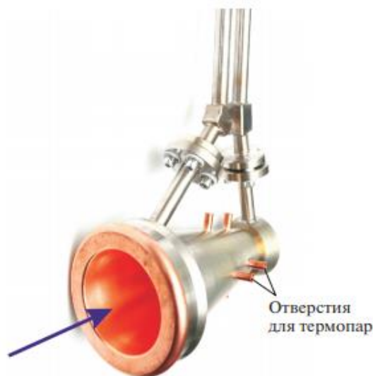
Рис. 40. Фотография цилиндра Фарадея. Направление распространения пучка ионов (атомов водорода) показано стрелкой
