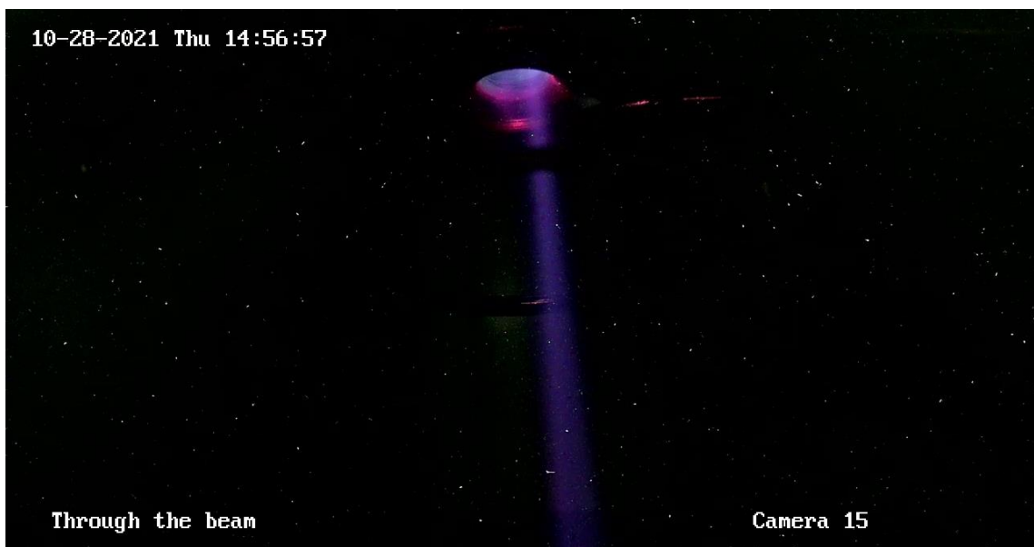
Рис. 31. Изображение с видеокамеры, направленной на входную охлаждаемую диафрагму ускорителя. Диафрагма в виде овального отверстия видна вверху по центру кадра; пучок ионов виден как синий луч; видимое прерывание пучка ионов перед входом в диафрагму обусловлено размещением металлического кольца под отрицательным потенциалом для подавления вторичной эмиссии электронов с проволочек сканера
