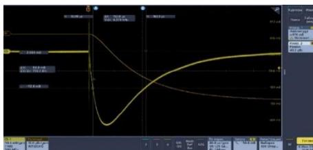
Рисунок 18 – Цилиндр Фарадея и сигнал с него в конце стенда линака
