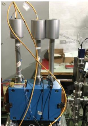
Рисунок 2 – Внешний вид магнитного спектрометра
