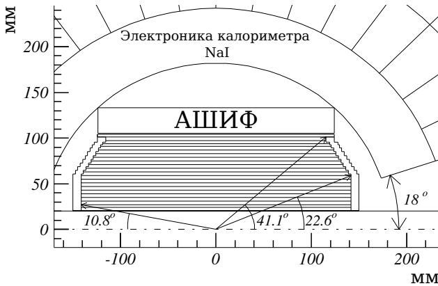
Рис. 6. Размещение системы аэрогелевых черенковских счётчиков (АШИФ) в детекторе СНД.
