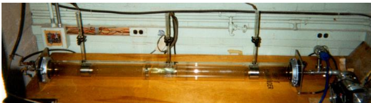
Рисунок 9. Фотография прототипа C-device, на котором получен нейтронный выход 10^7 н/с (DD) [64]
