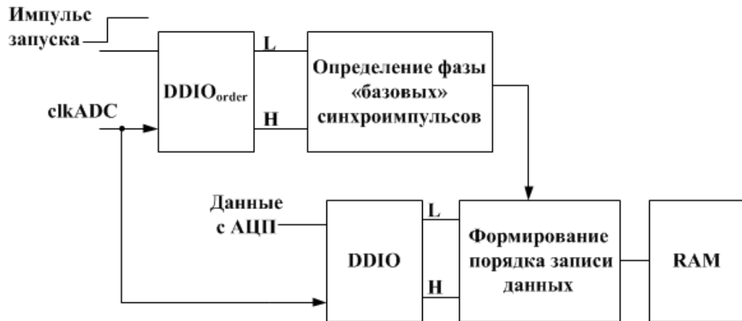
Рисунок 4.23. Организации порядка записи данных с выходов DDIO-приемников в RAM, зависящего от начальной фазы «базового» синхросигнала.
