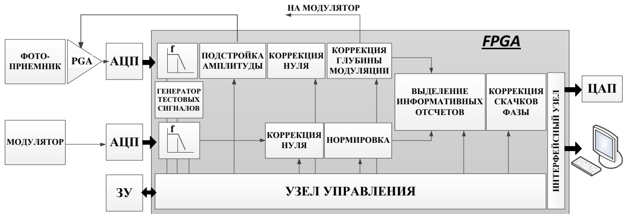
Рисунок 2.6. Схема построения фазометра. PGA – усилитель с программно-изменяемым коэффициентом передачи, f – фильтр.
