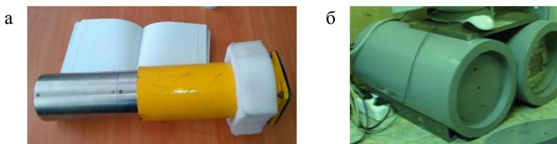
Рисунок 2.16. Фотографии регистратора интенсивного потока  $\gamma$ -квантов на основе сцинтилляционного детектора BGO: а — в сборе, б — в радиационной защите.
