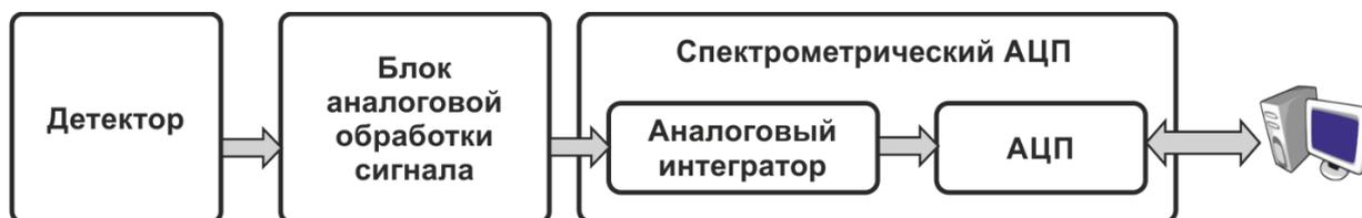
Рисунок 1.1. Блок-схема тракта регистрации на основе блока аналоговой обработки сигнала и спектрометрического АЦП.
