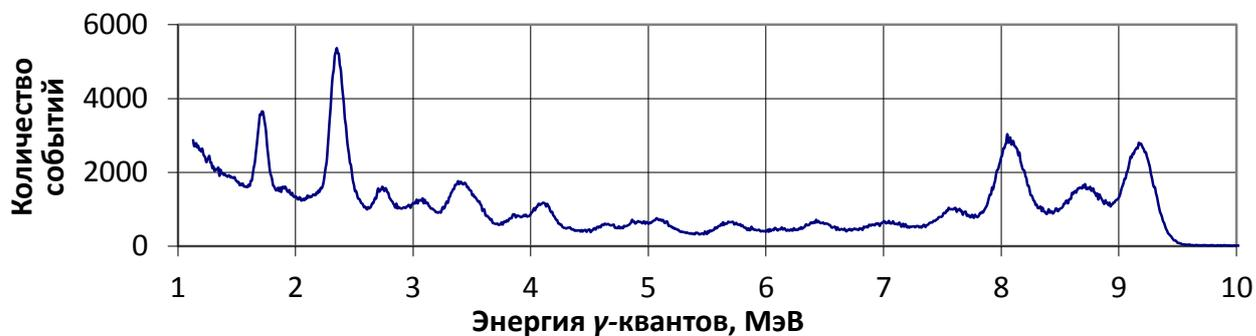
Рисунок 2.22. Энергетический спектр углеродной  $\gamma$ -образующей мишени при облучении протонным пучком с энергией  $\sim 1.75$  МэВ.
