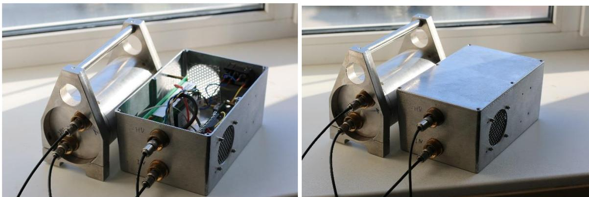
Рисунок 3.11. Фотографии анализатора потока быстрых нейтронов.
