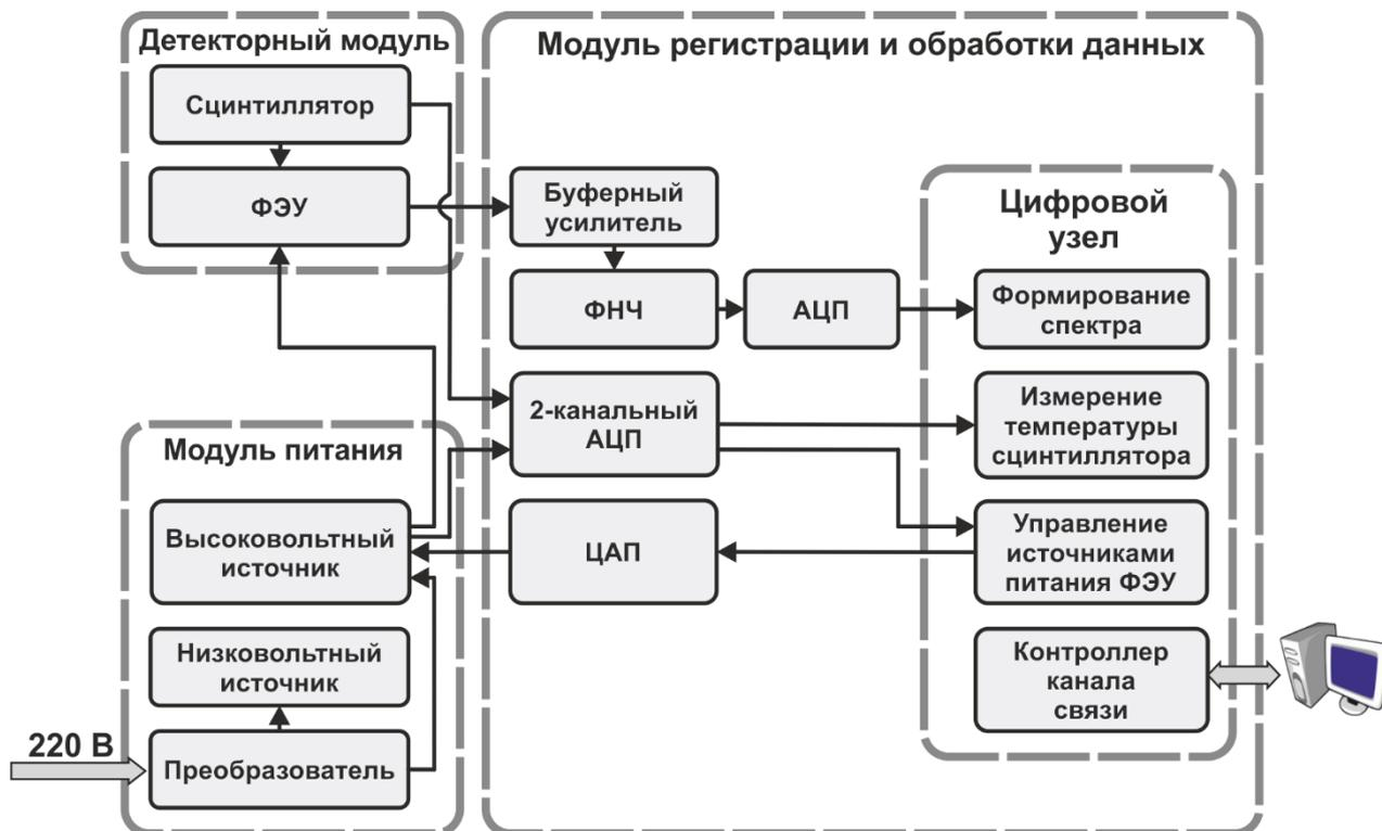
Рисунок 2.5. Функциональная блок-схема регистратора интенсивного потока  $\gamma$ -квантов с гауссовым цифровым формирователем.
