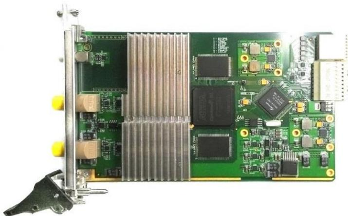
Рисунок 4.5. Фотография модуля ADC12500PXIe.
