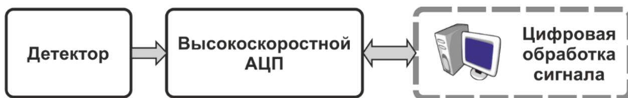
Рисунок 1.2. Блок-схема тракта регистрации на основе прямой оцифровки сигнала.
