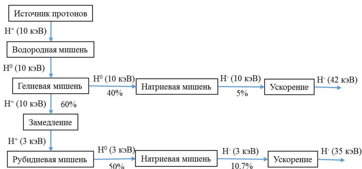
Рис. 1.2: Последовательность зарядово-обменных столкновений в источнике поляризованных ионов.
