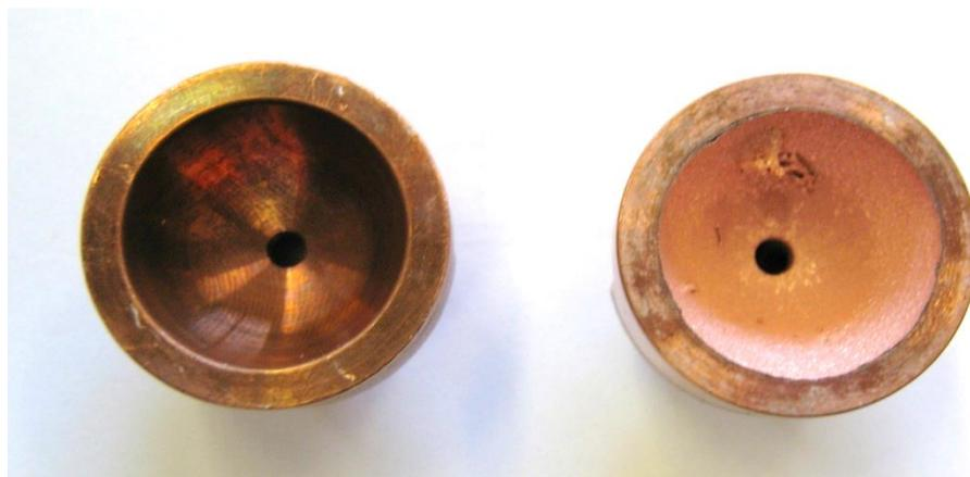
*Рис. 3.1: Фотография медных катодов: слева - новый, справа - после 72 часов работы с частотой 1 Гц, и длительностью импульса 500 мкс (интегральная длительность ~130 с).*
