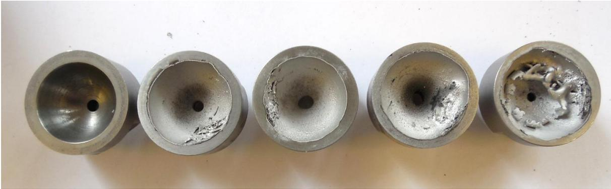
*Рис. 3.2: Фотография молибденовых катодов. Продолжительность непрерывной работы, слева направо: новый, 300 с, 600 с, 1300 с, 2600 с.*
