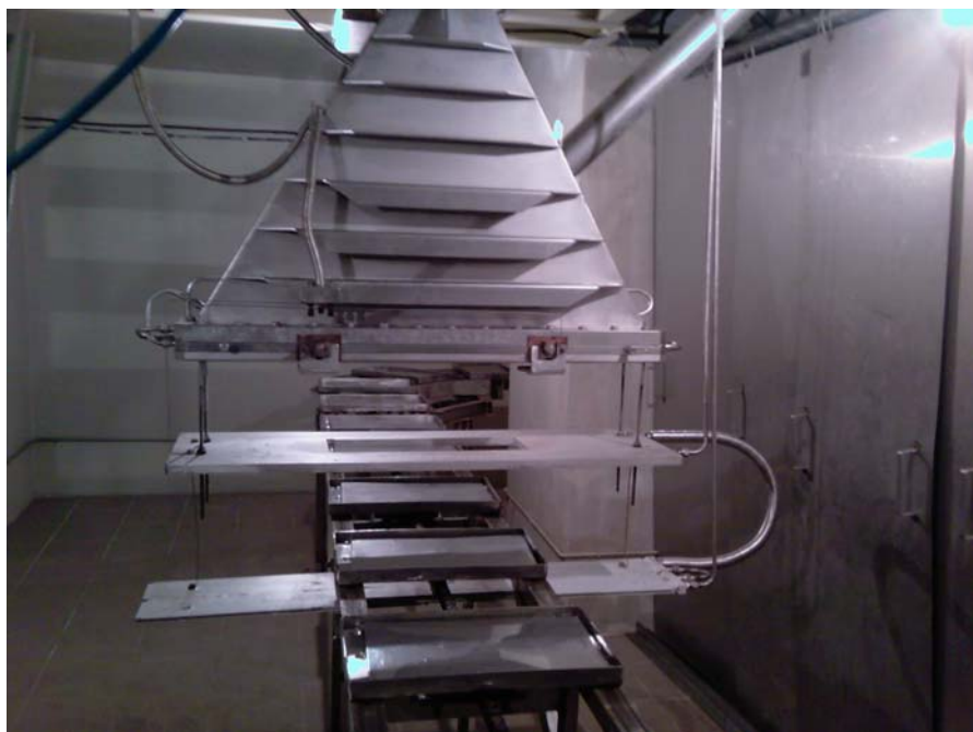
Рис. 5. Зона облучения комплекса – выпускное устройство ускорителя и конвейер.
