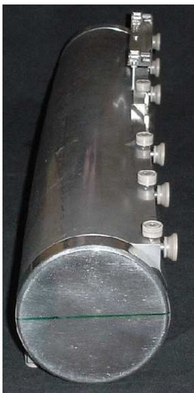
а) Фотография корпуса измерительной тележки. Внешний диаметр цилиндра составляет 90 мм.
