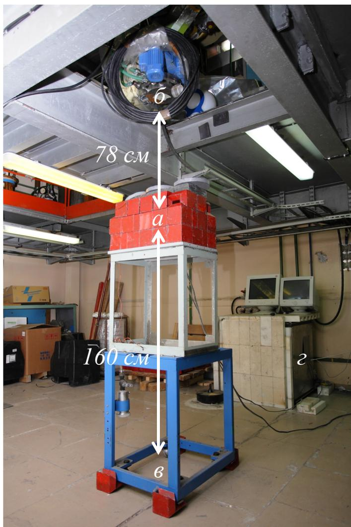
Рис. 46. На фотографии видно итоговое расположение детектора (а), окруженного свинцовой защитой, относительно мишени (б), пола (в) и помехозащищенного бокса с измерительной аппаратурой (z).
