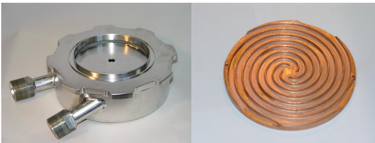
Рис. 13. Фотографии собранной мишени без приемника пучка (слева) и медного диска со стороны, охлаждаемой водой (справа).
