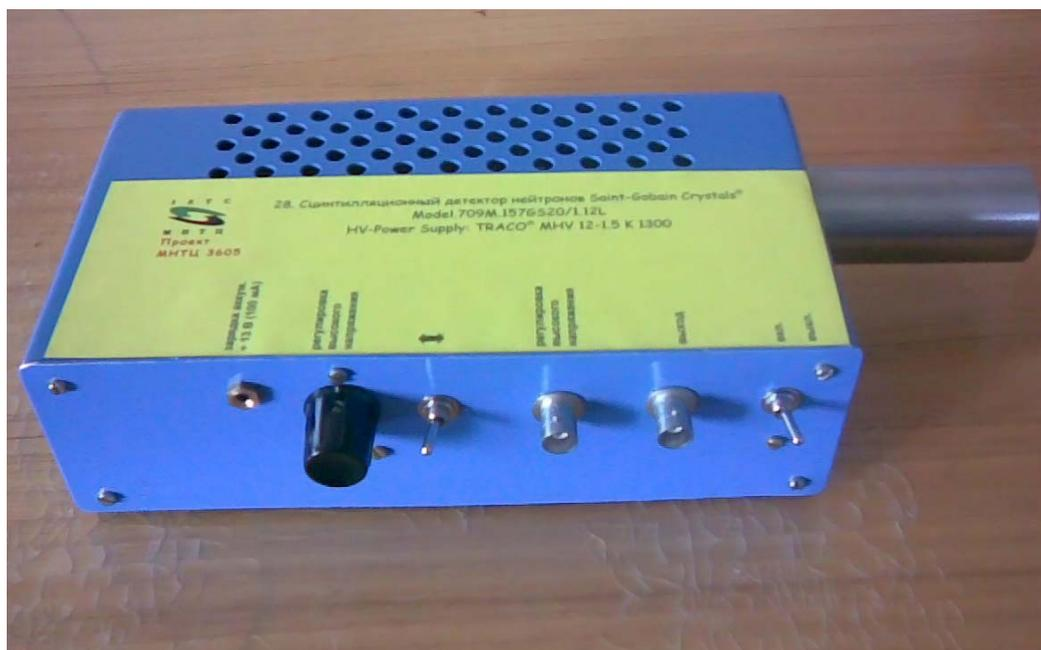
Рис. 19. Детектор и источник питания в сборке с аккумулятором.
