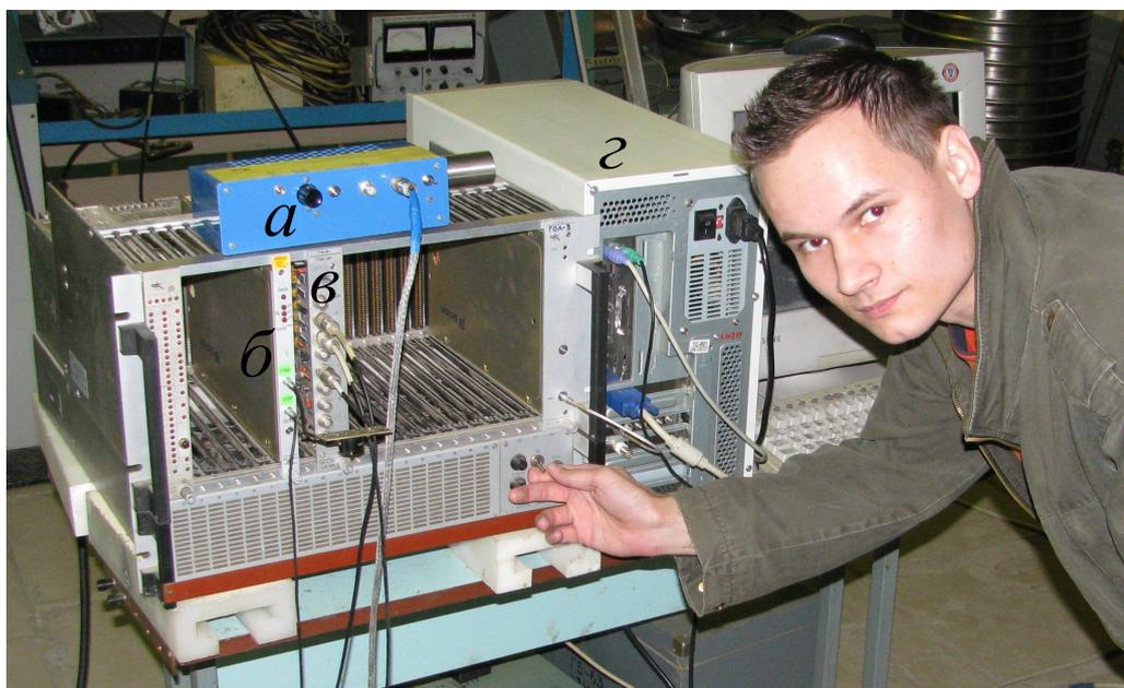
Рис. 25. Фотография оборудования для измерения времени пролета на этапе сборки: нейтронный детектор (а), ВЦП-1 (б), генератор стартовых импульсов (в), управляющая ЭВМ (г).
