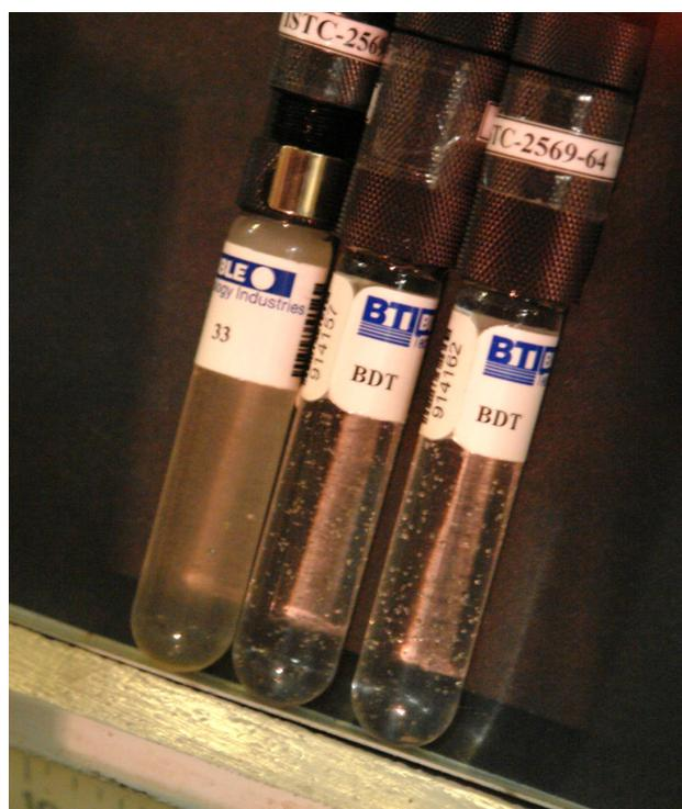
Рис. 36. Состояние пузырьковых детекторов после эксперимента: на левой фотографии показаны два детектора BDT, на правой – детектор BD100R (слева) и два детектора BDT.
