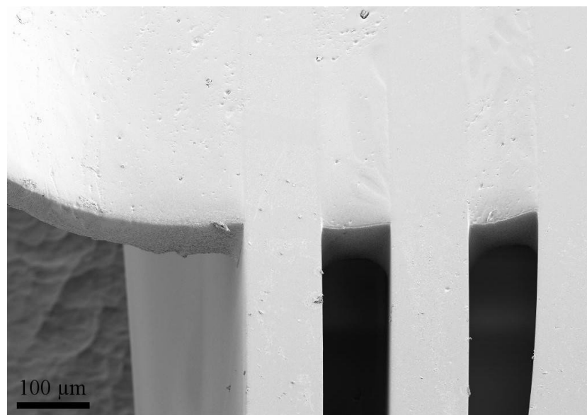
Рисунок 1-18. РЭМ-фотография поддерживающего суб-слоя из резиста mr-L5100PXP, применяемого для механической стабилизации ламелей шириной от 20 до 200 мкм и высотой 500 мкм.
