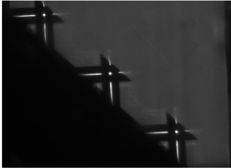
Рисунок 3-51. Изображение на CCD камере преломляющих линз с адиабатическим сужением, отъюстированных параллельно лучу СИ при энергии квантов 18,6 кэВ на станции P05(PETRA-III).
