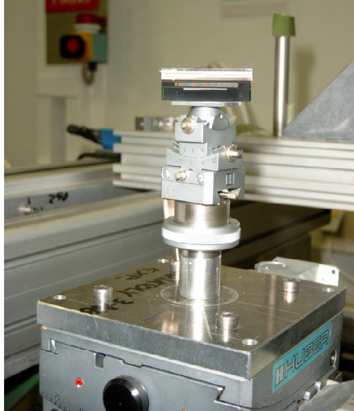
Рисунок 4-15. Ориентированная вертикально никелевая линза с киноформным профилем, смонтированная на моторизованном столике на станции ID-15A(ESRF).
