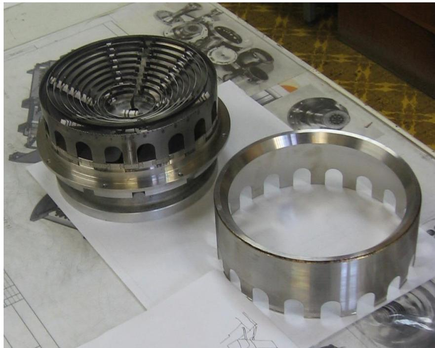
**Рис. 4.** Внешний вид деталей катодного узла ЛИУ-2
