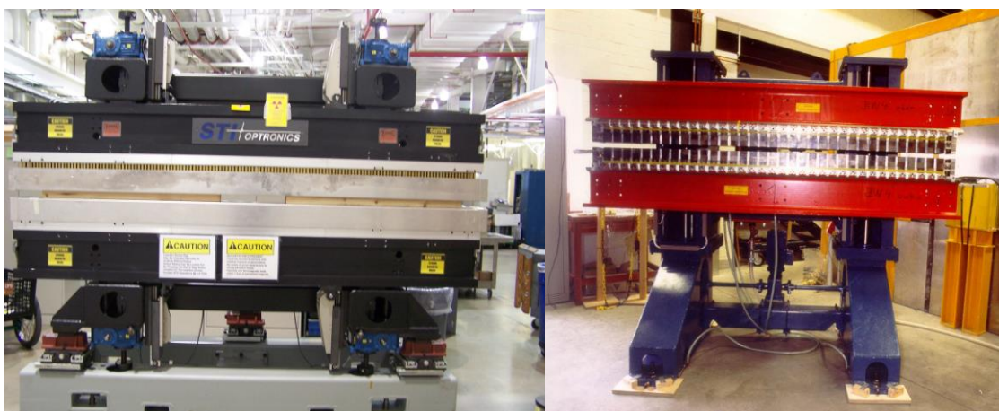
Рисунок 50. Левый: APS Undulator A. Правый: C-Frame Hasylab W1 wiggler 1984. Spindle guided.
