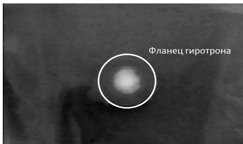
Рисунок 1.5 — Пример ИК-изображения микроволнового пучка, прошедшего через частично поглощающий экран
