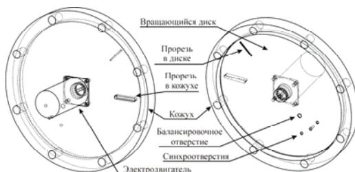
Рис. 5. Конструкция быстрого затвора.
