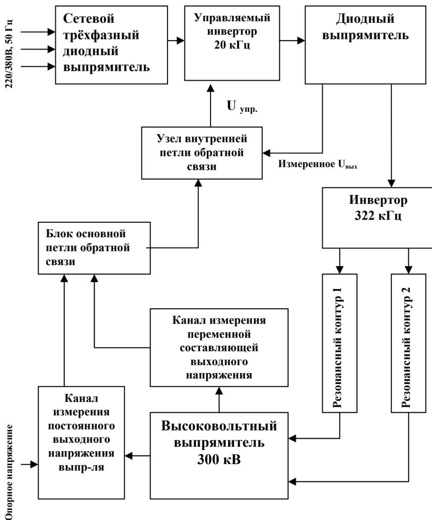
Рис.6. Структурная схема высоковольтного источника питания.
