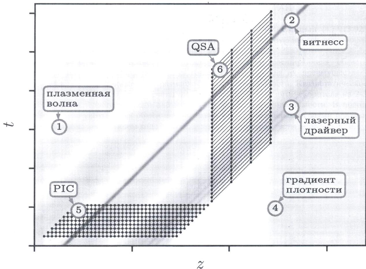
Объекты, моделируемые в задачах плазменного кильватерного ускорения: плазменная волна (1), ускоряемый пучок (2), лазерный драйвер (3), градиент плотности плазмы (4). Расчетные сетки, используемые в обычных PIC кодах (5) и в квазистатических кодах (6).
