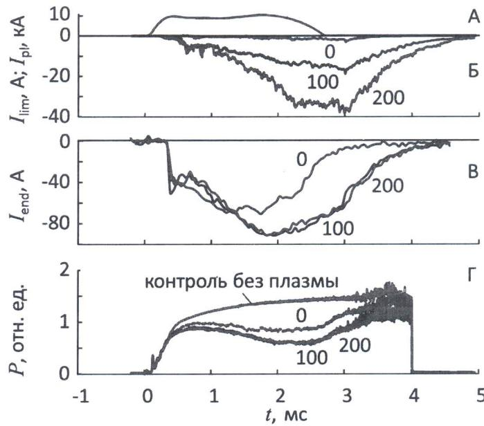
Рисунок: Сигналы: (А) ток плазменной пушки, (Б) ток лимитера, (В) ток плазмоприёмника, (Г) мощность прошедшего сквозь плазму нагревного пучка (чем меньше – тем лучше). Цифры у кривых – напряжение на лимитерах
