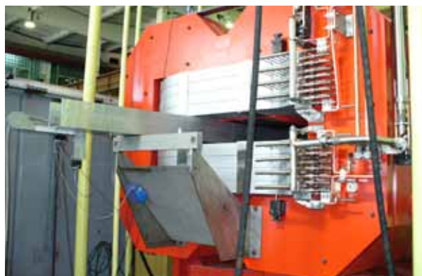
Рис.(6.5)2. Радиационно-стойкий дипольный магнит на стенде магнитных измерений.
