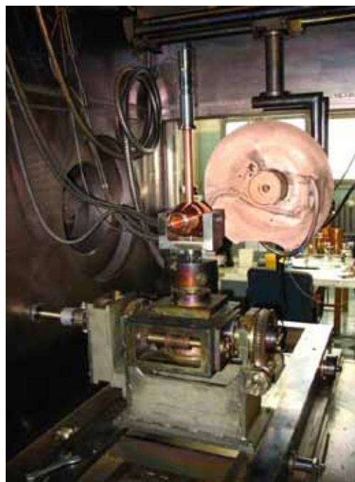
Рис. (7.13)3. Трубка дрейфа в камере установки ЭЛС.
