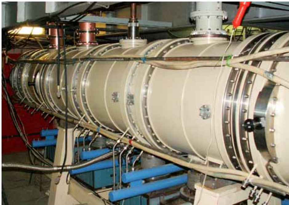
Рис. (7.5)6. Ускоряющая структура после настройки вводов мощности.
