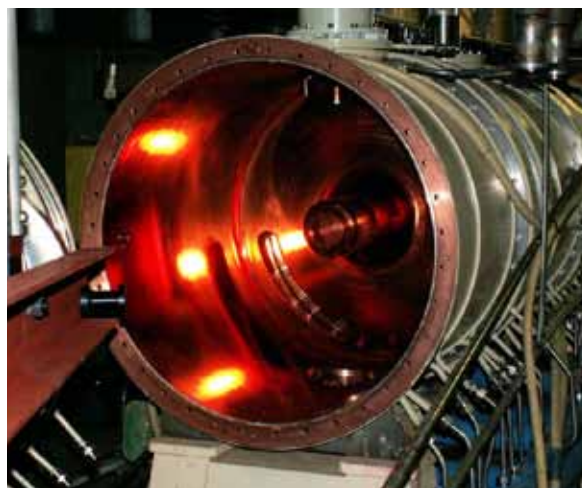
Рис.(7.5)3. Вид на ускоряющую ячейку во время сборки структуры.
