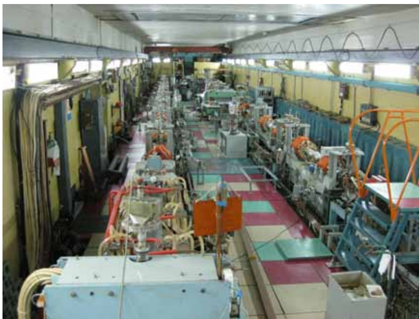
Рис.(5.3)1. Линейный ускоритель позитронов Инжекционного комплекса ВЭПП-5.
