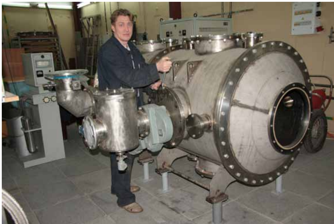
Рис.(5.5)5. Вакуумная камера сварочной установки, разрабатываемой по тематике МНТЦ «Разработка вакуумной системы и технологии её производства для электрон-позитронных коллайдеров высокой интенсивности».
