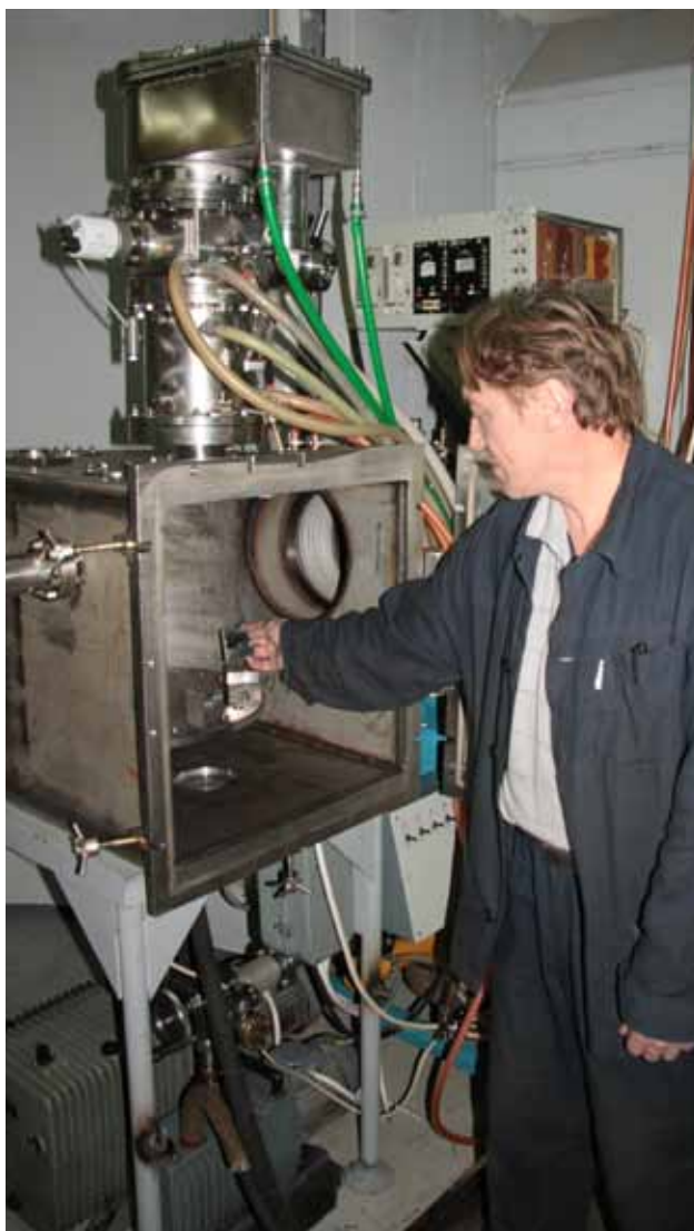
Рис.(5.5)1. Электронно-оптическая колонна с косвенным подогревом катода электронной бомбардировкой на экспериментальном объёме.
