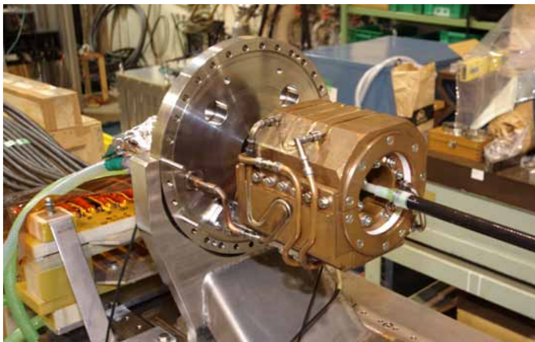
Рис.(5.13)2. Импульсный магнит для позитронного источника Super-B фабрики КЕК.
