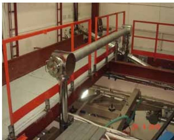
Рис.(6.4)22. – Канал вывода излучения ЛСЭ второй очереди (средняя часть). Излучение, приходящее снизу, отразившись от двух зеркал, попадает в «старую» часть канала (вдали) через узел подвижного зеркала.
