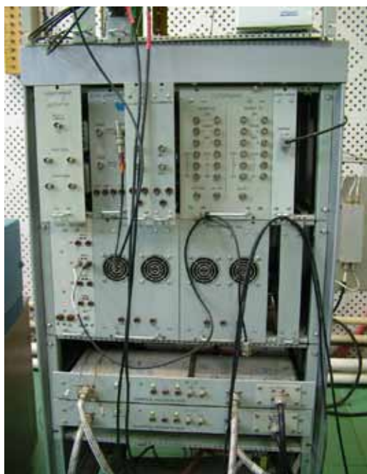
Рис.(5.2)9. Система продольной обратной связи ВЭПП-4М.
