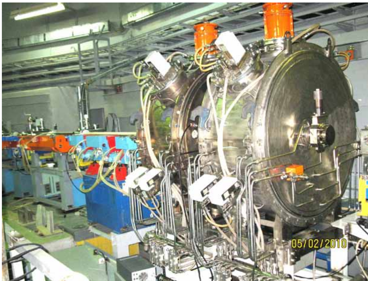
Рис. (7.9)1. Два ускоряющих резонатора в кольце накопителя 2,2 ГэВ.
