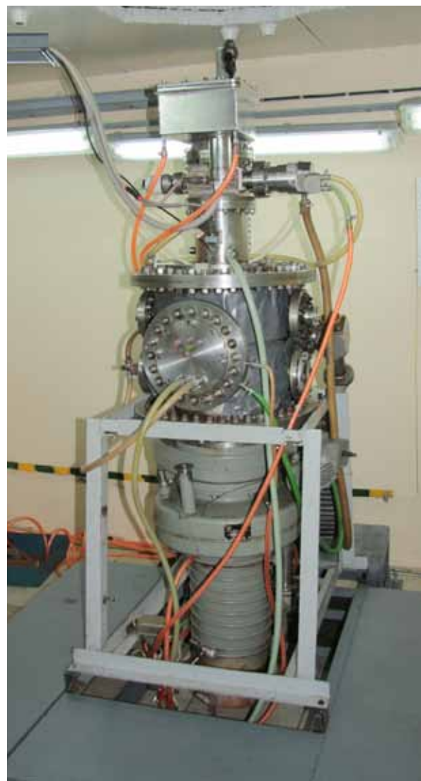
Рис.(5.5)2. Электронно-оптическая колонна, модернизированная для НИТИ «Прогресс» на экспериментальном объёме.
