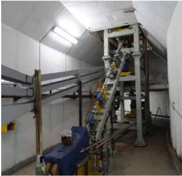
Рис.(5.3)6. Элементы канала на ВЭПП – 3 с контуром системы охлаждения.
