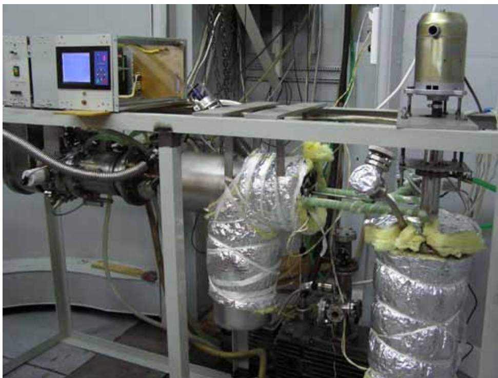
Рис.(5.5)4. Сварочная пушка в составе стенда для испытаний защитного окна с жидким свинцом.
