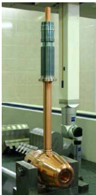
Рис. (7.13)2. Пилотный образец трубки дрейфа.
