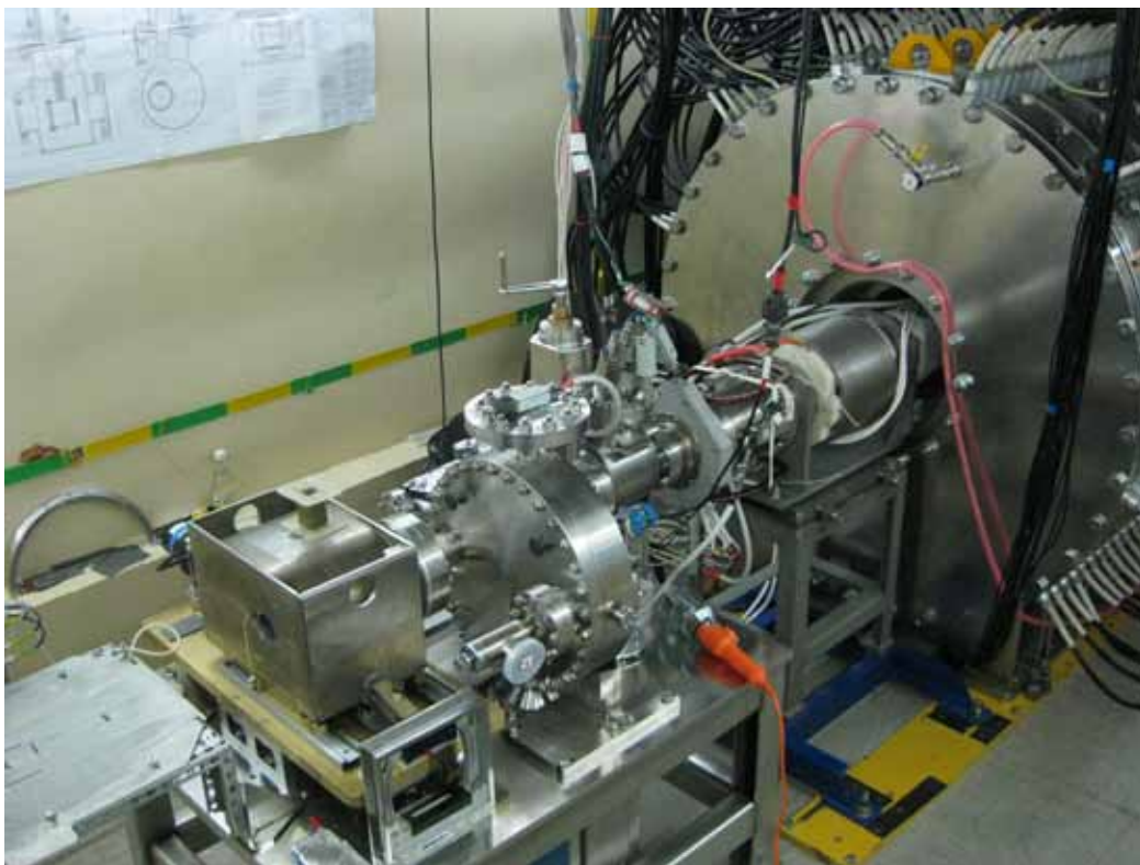
Рис.(5.4)2. Мишенный узел и ускоряющая часть (вид спереди).
