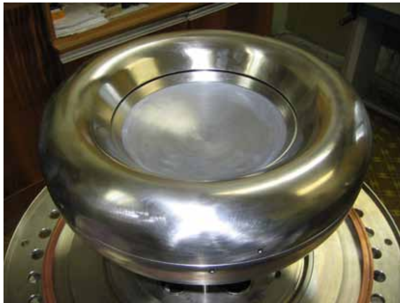
Рис.(5.6)4. Общий вид катодного узла ускорителя ЛИУ – 2 на тестовом фланце.
