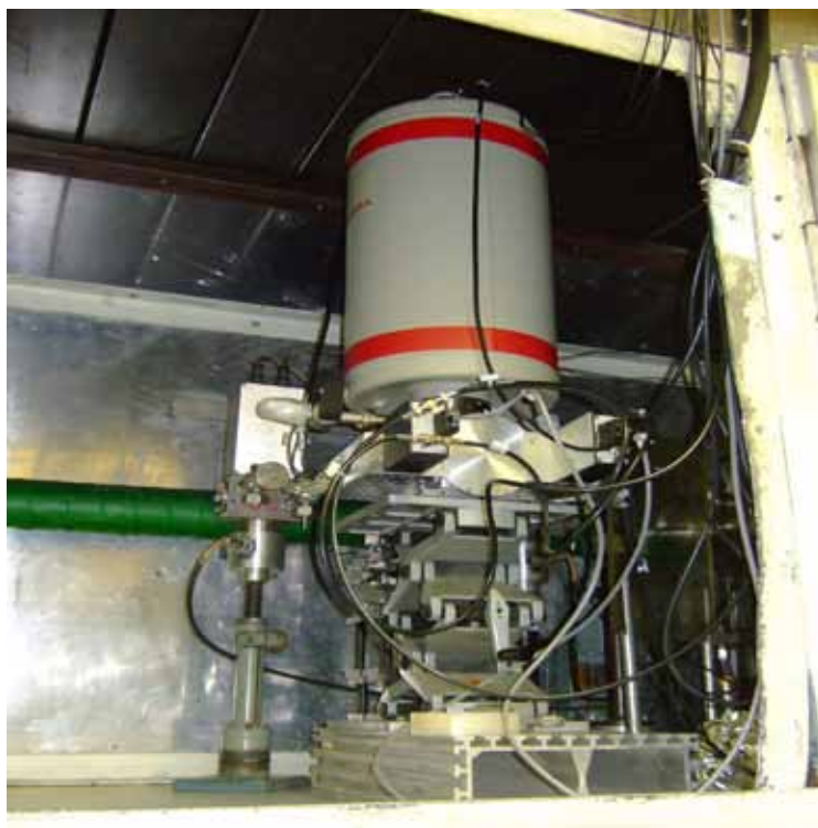
Рис.(6.2)31. 9-элементный детектор компании Sanbeга установленный на 8 канале СЦСИ (станция EXAFS спектроскопии).
