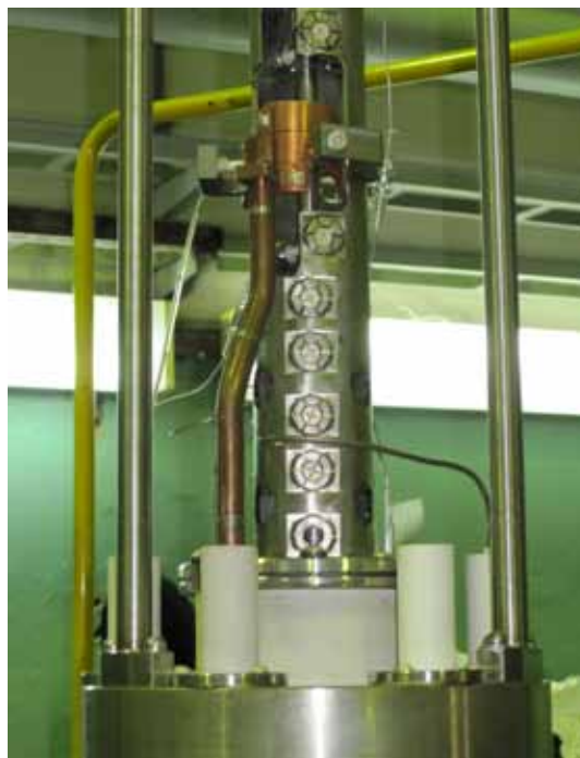
Рис. (5.11)2. Система дозированного напуска атомов твердых элементов и внутренняя часть газовой системы.
