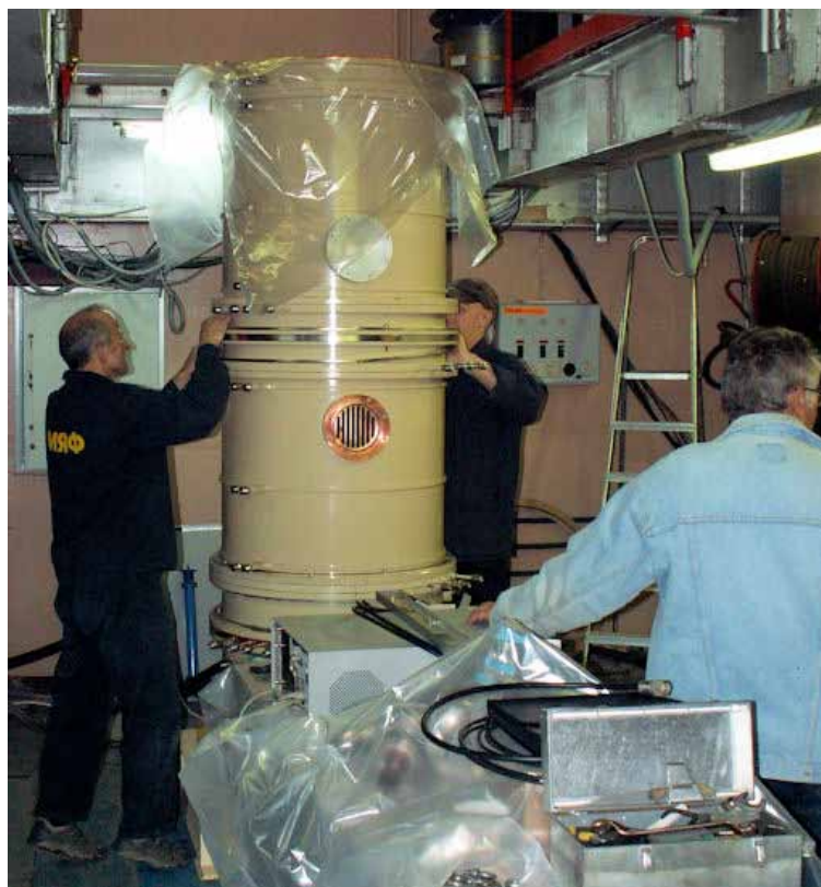
Рис. (7.5)1. Секция ускоряющей структуры в вертикальном положении.
