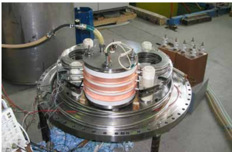
Рис.(5.7)2. Секция трансформатора на испытаниях.
