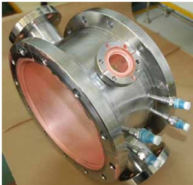
Рис.(7.13)5. Ячейка связи первого модуля после нанесения медного покрытия.
