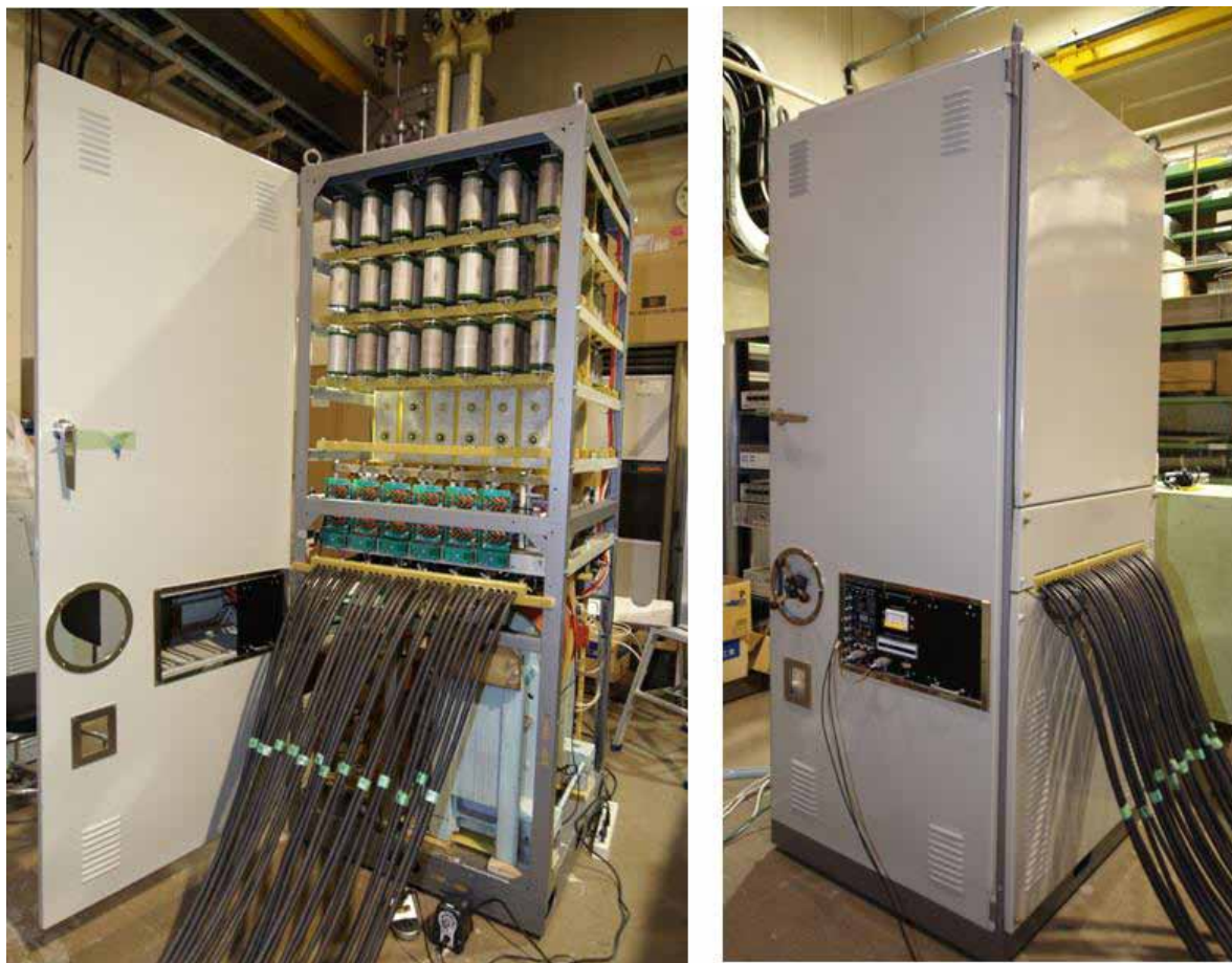
Рис.(5.13)1. Генератор импульсного питания конверсионного магнита
