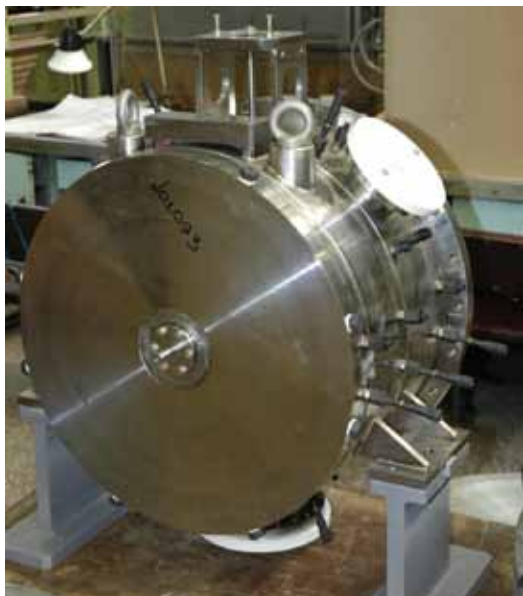
Рис.(7.13)4. Корпус резонатора 1-го модуля, подготовленный к вакуумным испытаниям.
