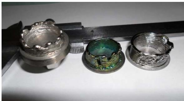
Fig. 5.5.3. Samples grown from tungsten wire.
