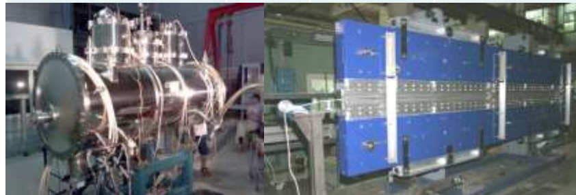
Сверхпроводящий 72-полюсный вигглер с полем 3Т для источника СИ ANKA, Карлсруэ, Германия
