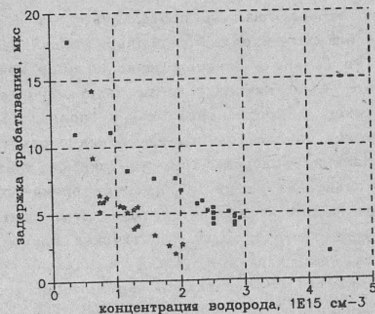
Рис. 8. Зависимость задержки пробоя от концентрации водорода для напряжения зарядки батареи 16 кВ (квадраты) и 18 кВ (звездочки).
