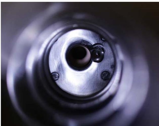
Рис. 3. Фотография диафрагмы высоковольтного электрода.
