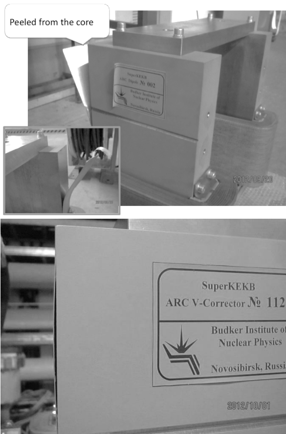
Рис. 8. Фотографии корректоров с отслоившейся краевой пластиной.
