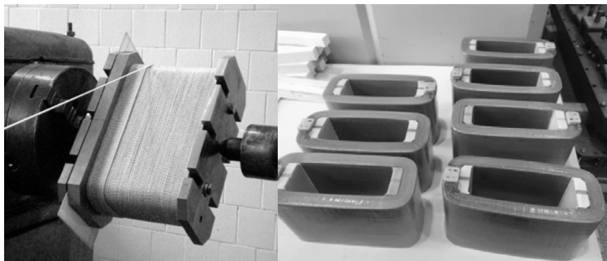
Рис. 2 . Намоточное устройство и изготовленные катушки.
