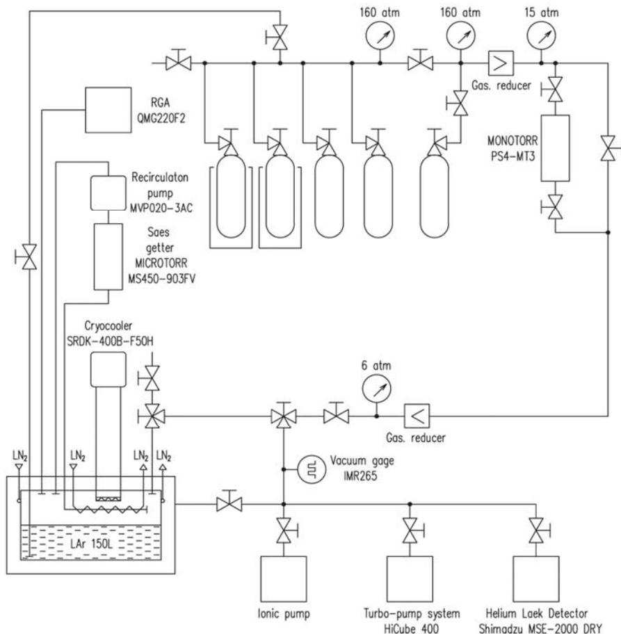
Рис. 3. Схема криогенной и вакуумной системы двухфазного КЛД с криогенной камерой объёмом 160 л.
