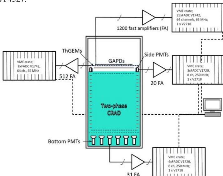
Рис. 5. Схема системы сбора данных двухфазного КЛД с криогенной камерой объёмом 160 л
