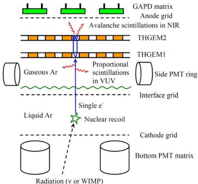
Рис. 1. Принцип работы двухфазного КЛД в Ar с оптическим считыванием с комбинированным множителем ГЭУ/ГЛФД-матрица
