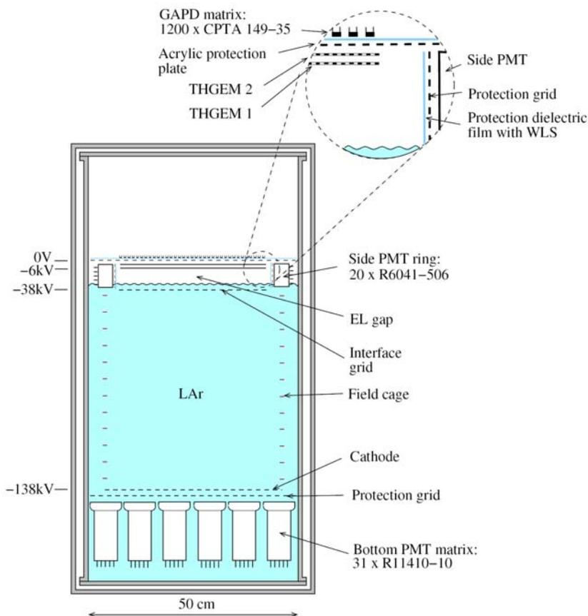
Рис. 2. Схема двухфазного КЛД в Ar с оптическим считыванием с комбинированным умножителем ГЭУ/ГЛФД-матрица для поиска тёмной материи и регистрации когерентного рассеяния нейтрино, с криогенной камерой объёмом 160 л, разрабатываемого в нашей лаборатории
