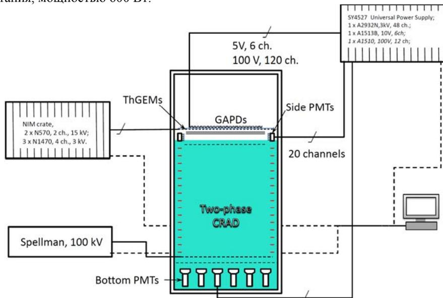
Рис. 4. Схема питания двухфазного КЛД с криогенной камерой объемом 160 л.
