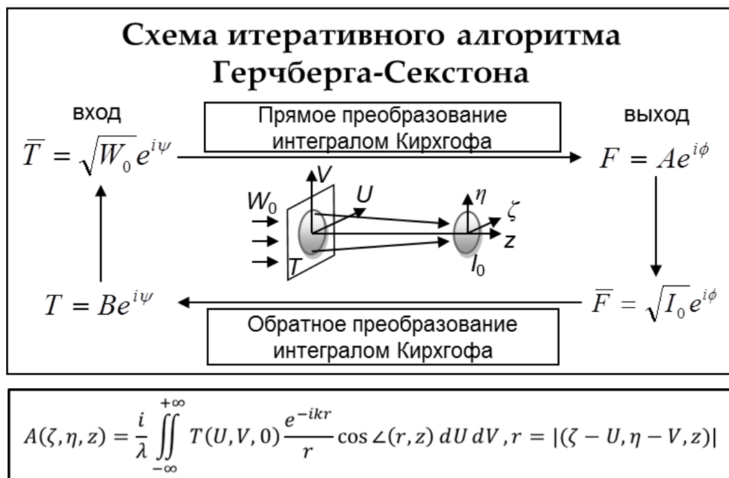
Рис. 18: Схема итерационного метода расчёта фазы фокусирующего элемента на примере схемы Герцберга-Секстона; снизу – выражение для интеграла Кирхгофа.
