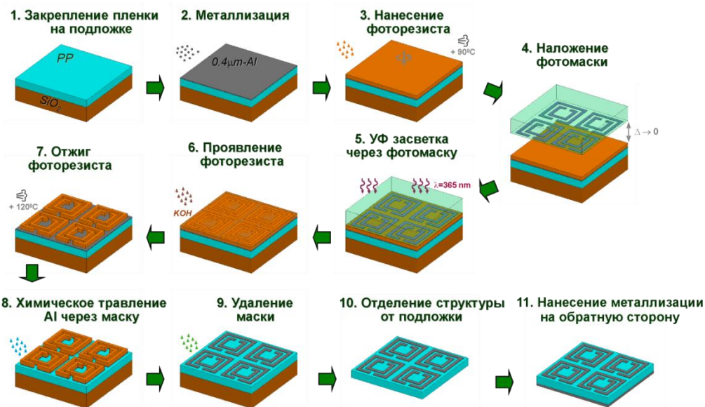
Рис. 4. Технологические стадии создания однослойных металлизированных микроструктур с помощью техники контактной фотолитографии.
