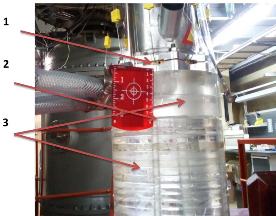
Рис. 7. Схема эксперимента. 1 – литиевая нейтроногенерирующая мишень с медной подложкой, 2 – место для облучения образца, 3 – замедлитель из органического стекла, фантом
