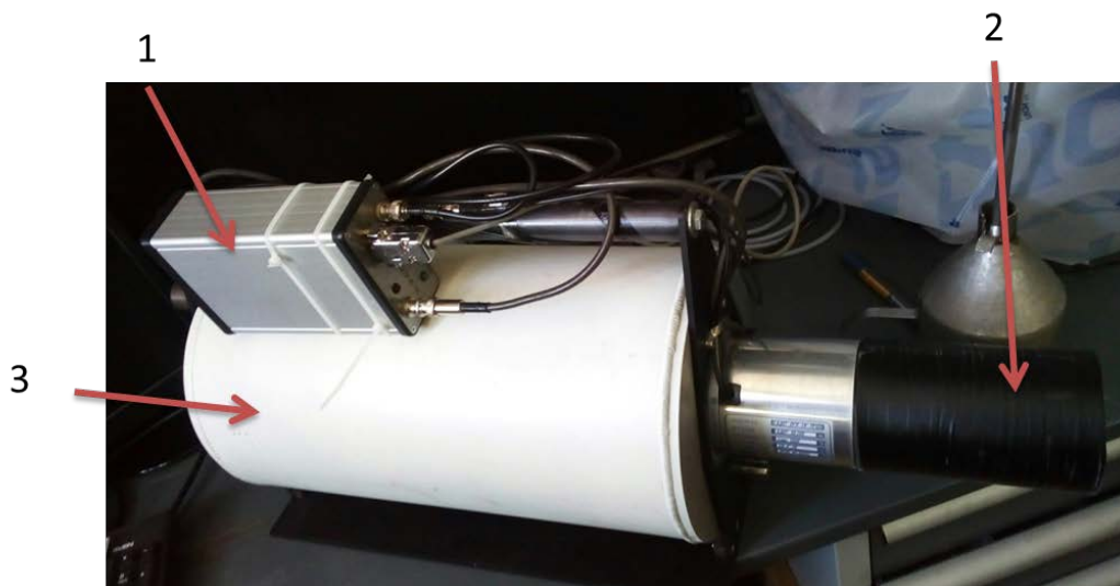
Рис. 4. Схема HPGe-детектора. 1 – система питания, 2 – высокочистый германий, 3 – система охлаждения
