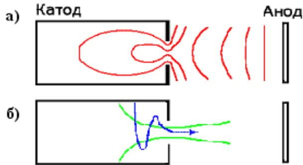
Рис. 2. а) Распределение потенциала в тлеющем разряде с полым катодом
