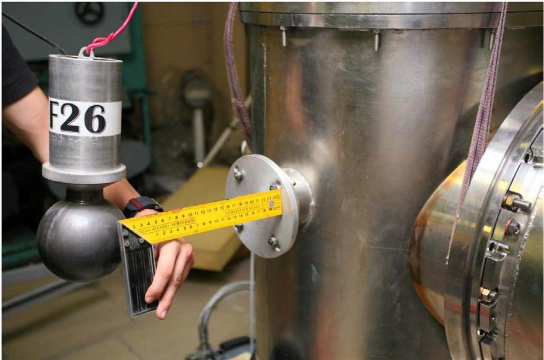
Рис. 13. Блок детектирования системы АСРМ.
