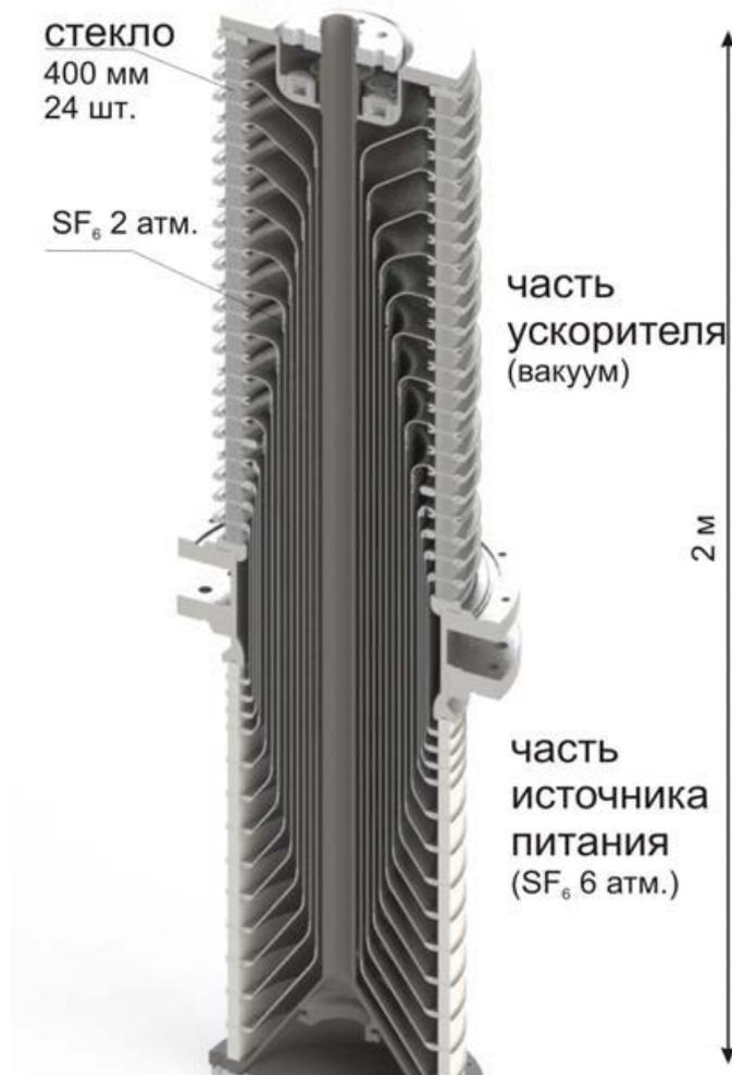
Рис. 5. Проходной изолятор.
