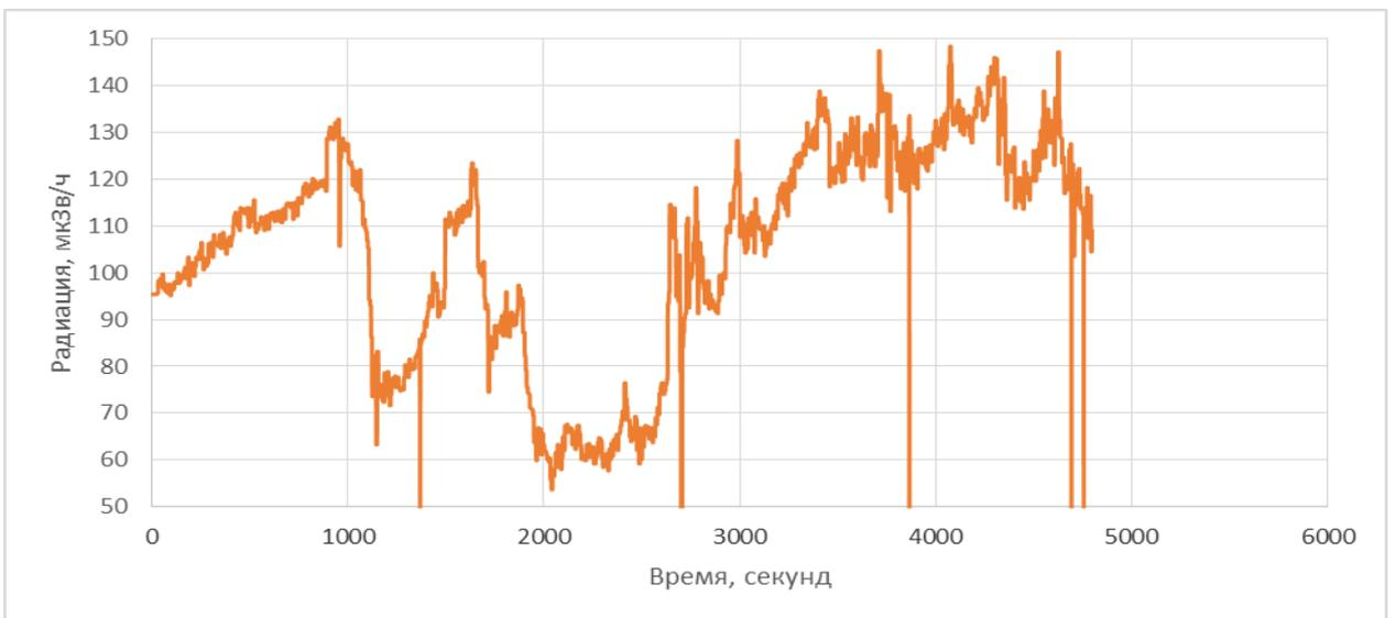
Рис. 20. Зависимость мощности дозы от времени при выстойки ребристого керамического изолятора на напряжениях 100 и 105 кВ.
