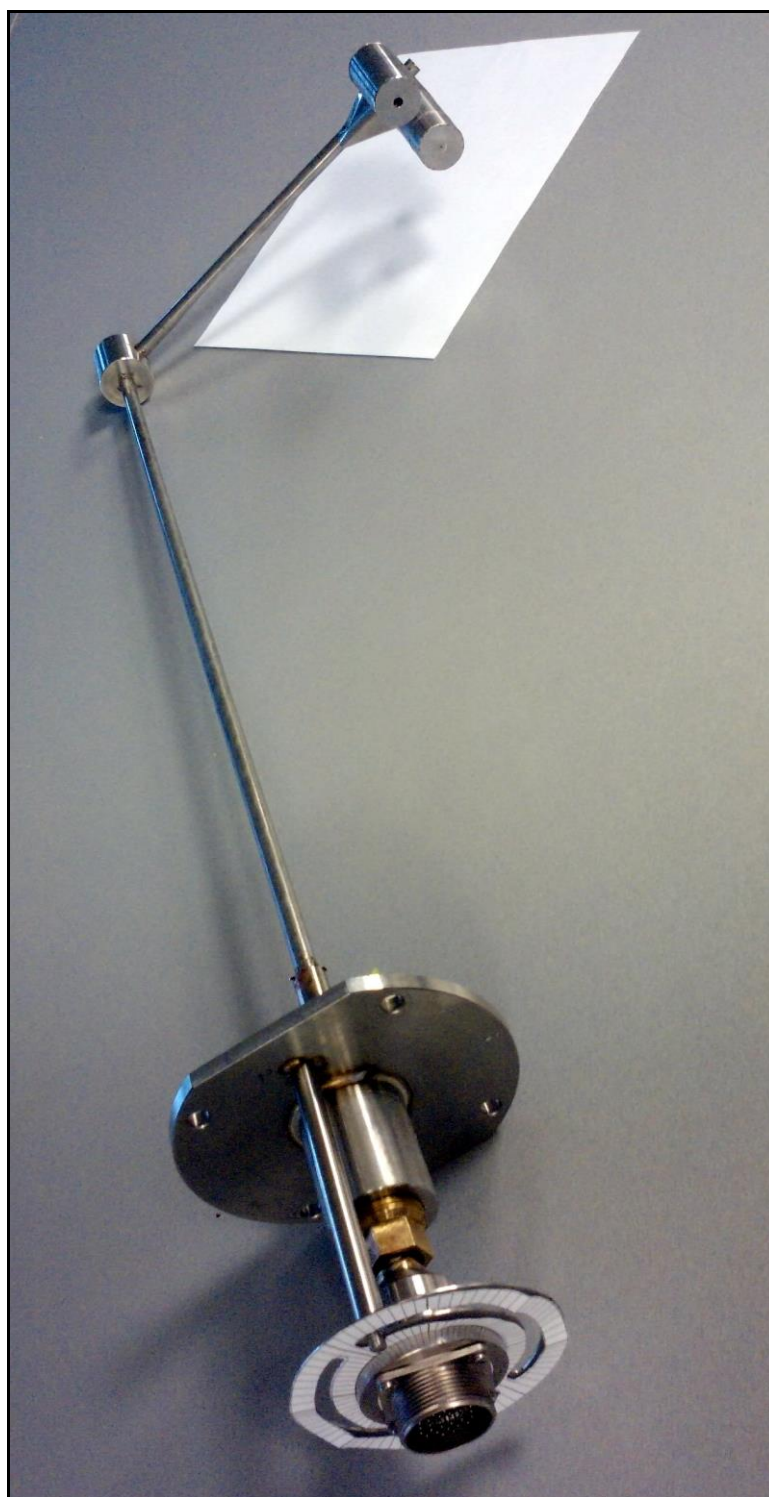
Рисунок 8. Фотография пирозлектрического болометра и двухсеточного зонда на подвижном устройстве
