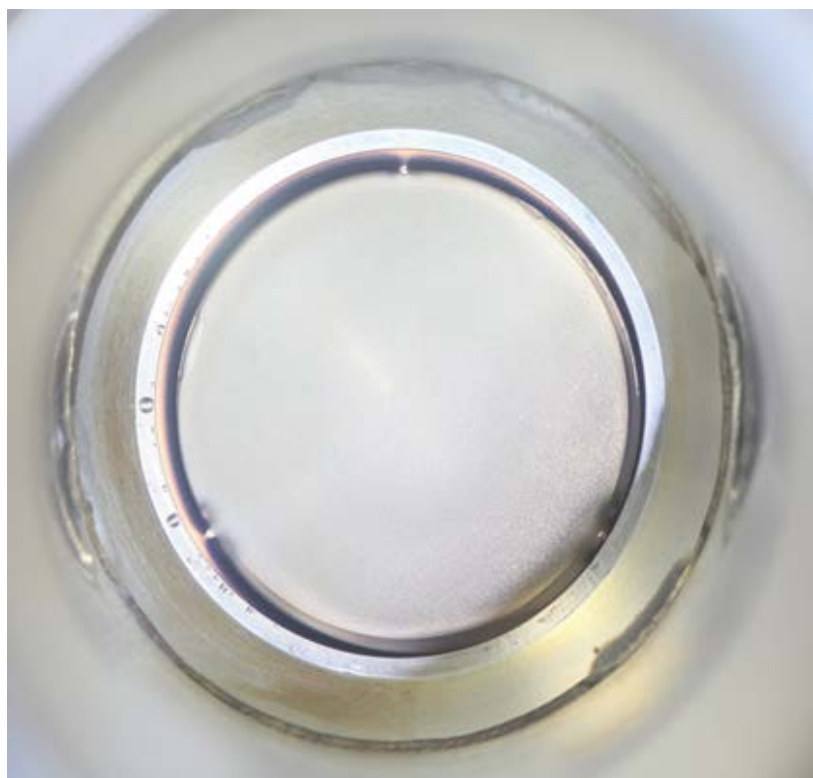
Рисунок 5. Мишень с нанесенным слоем лития
