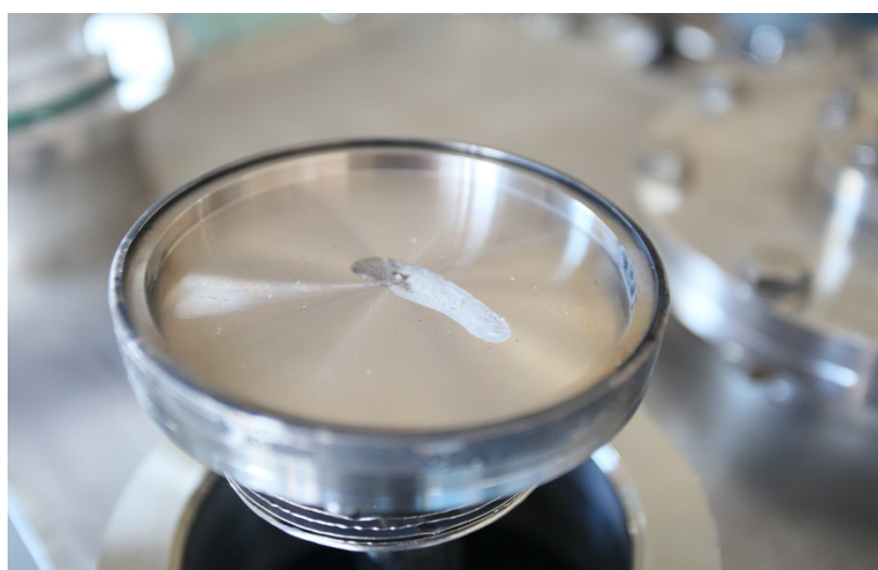
Рисунок 4. Нагревательная тарелка со следами лития
