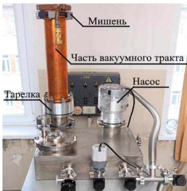
Рисунок 3. Стенд термического напыления лития
