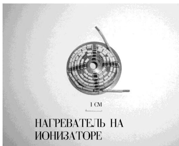
Рис.5 Внешний вид танталовой чашки ионизатора с обратной стороны.
