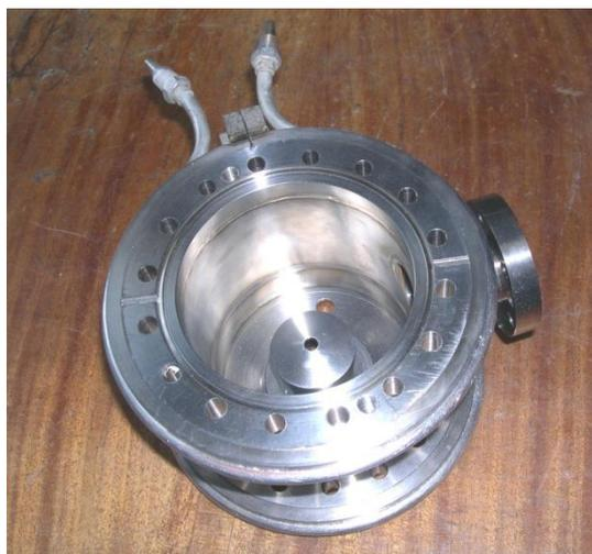
Рис. 2 Внешний вид корпуса источника. Внутри виден экстрактор.
