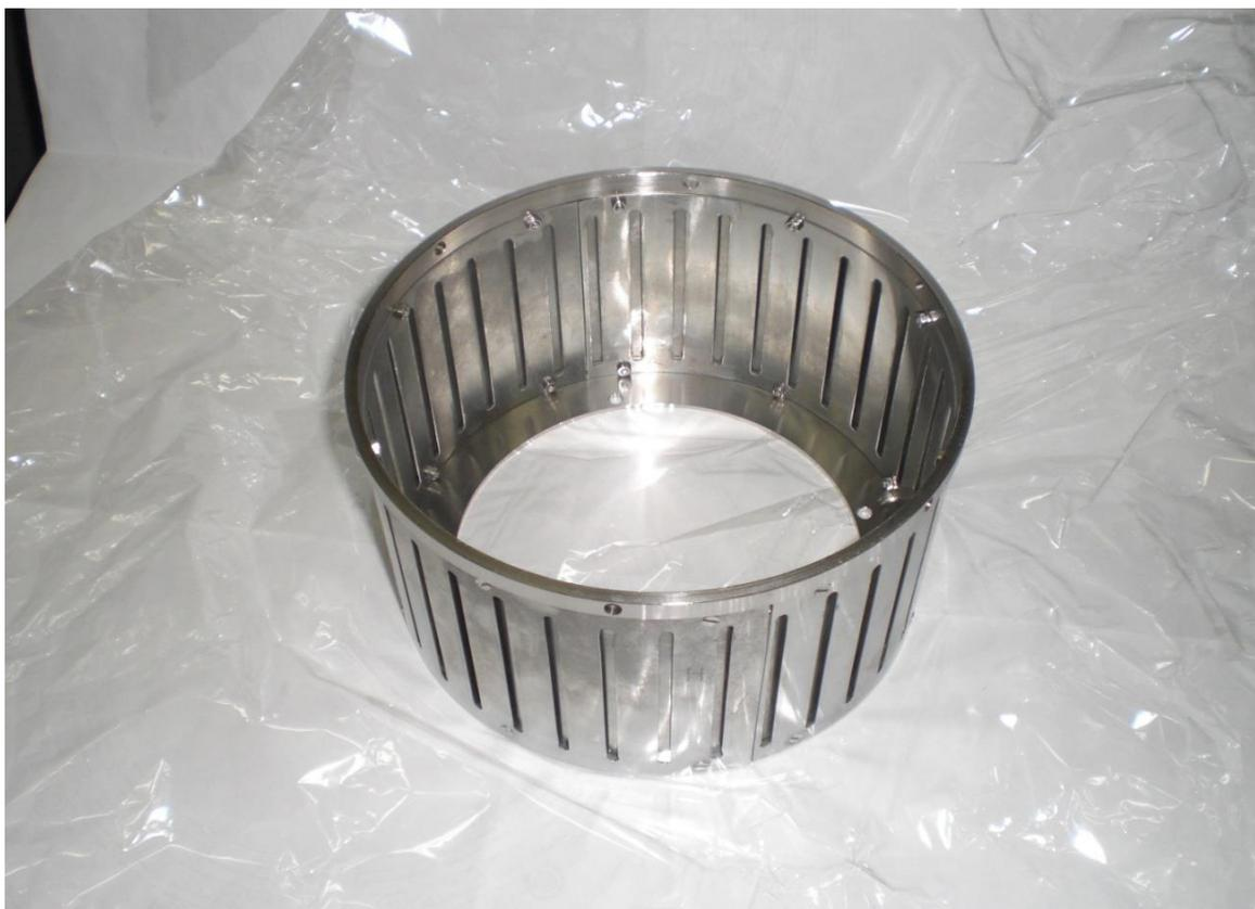
*Рис.4. Фото двухслойного молибденового фарадеевского экрана.*
