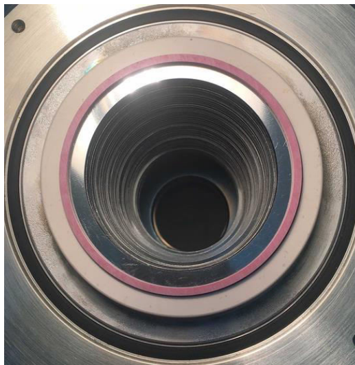
Рис. 8. Система плавающих диафрагм. Вид со стороны анода.
