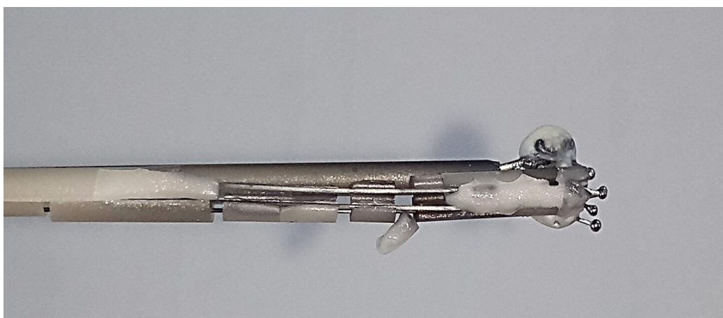
Рис. 17. Результат воздействия секундного плазменного потока на зонд в области оси плазменного шнура при новой конфигурации плазменной пушки.
