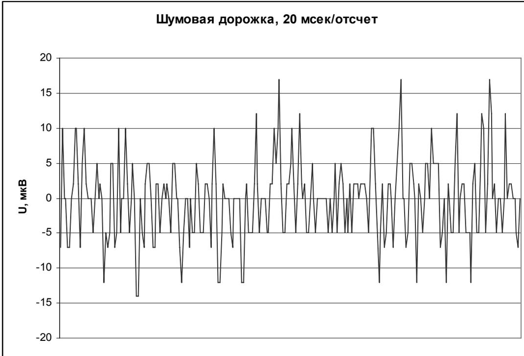
Типичная шумовая дорожка для АЦП. Измерения производились в одноканальном режиме, время измерения 1 мс/отсчет.
